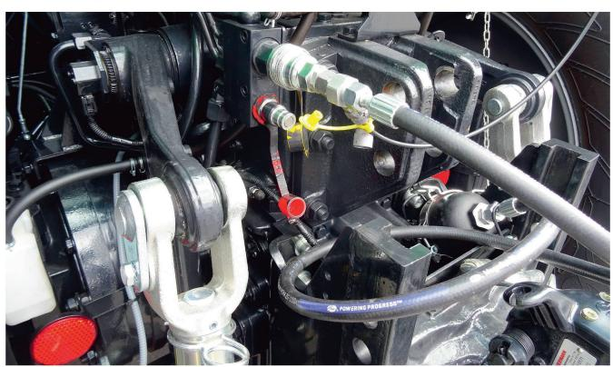
Technisch zwar möglich, aber nicht erlaubt: Das Ankuppeln eines hydraulischen Einleiter-Anhängers an ein Zweileiter-Bremssystem beim Traktor – ausser das Bremssystem ist «intelligent» und erkennt, ob es sich um einen Einleiter-Anhänger handelt. Bild: R. Engeler
