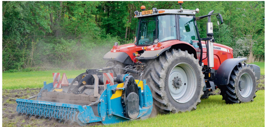
Der Antrieb erfolgt einseitig durch ein Stirnradgetriebe auf der rechten Maschinenseite. Als Nachläufer ist eine Zahnpackerwalze angebaut.
