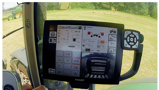
Die Bedienung der Isobus-kompatiblen Presse erfolgt übersichtlich über das Traktor-Terminal.
