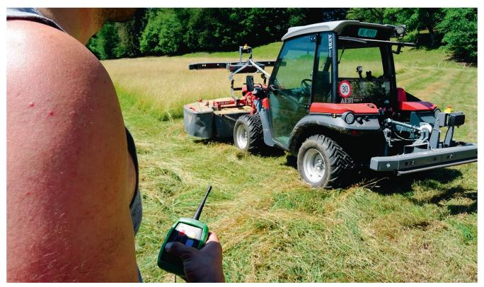
Der Aebi «TT 211» mäht auf dieser Parzelle das hoch stehende Gras selbstständig. Die Bedienperson kann per Knopfdruck am kleinen Handgerät die Maschine starten und stoppen. Bilder: R. Engeler
