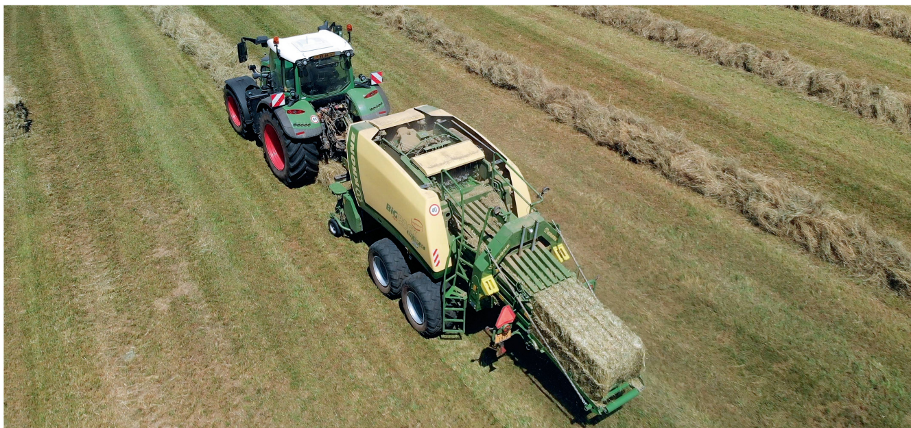
Die Ernteleistung der «Big Pack 870 HDP XC HighSpeed» ist mit aktiver «MultiBale»-Funktion etwa so gross wie die von zwei bis drei HD-Kleinballenpressen. Bilder: R. Burkhalter
