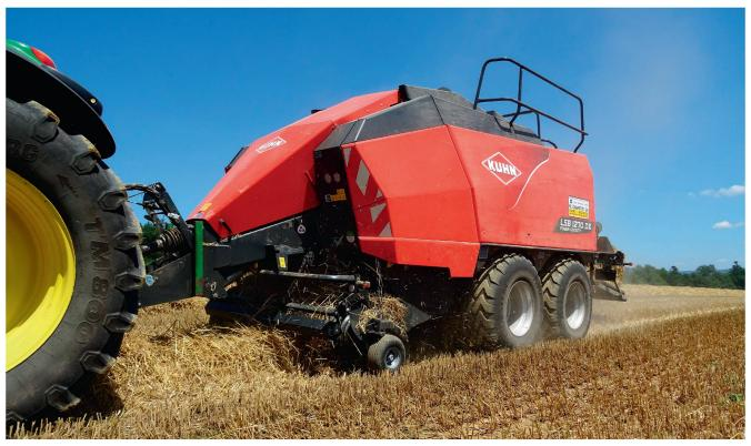
Die Quaderballenpresse «LSB 1270 DX» brachte Kuhn 2017 auf den Markt. Die Maschine ist für besonders «harte» Ballen mit Kanalmass 120 x 70 cm ausgerichtet. Bilder: R. Engeler
