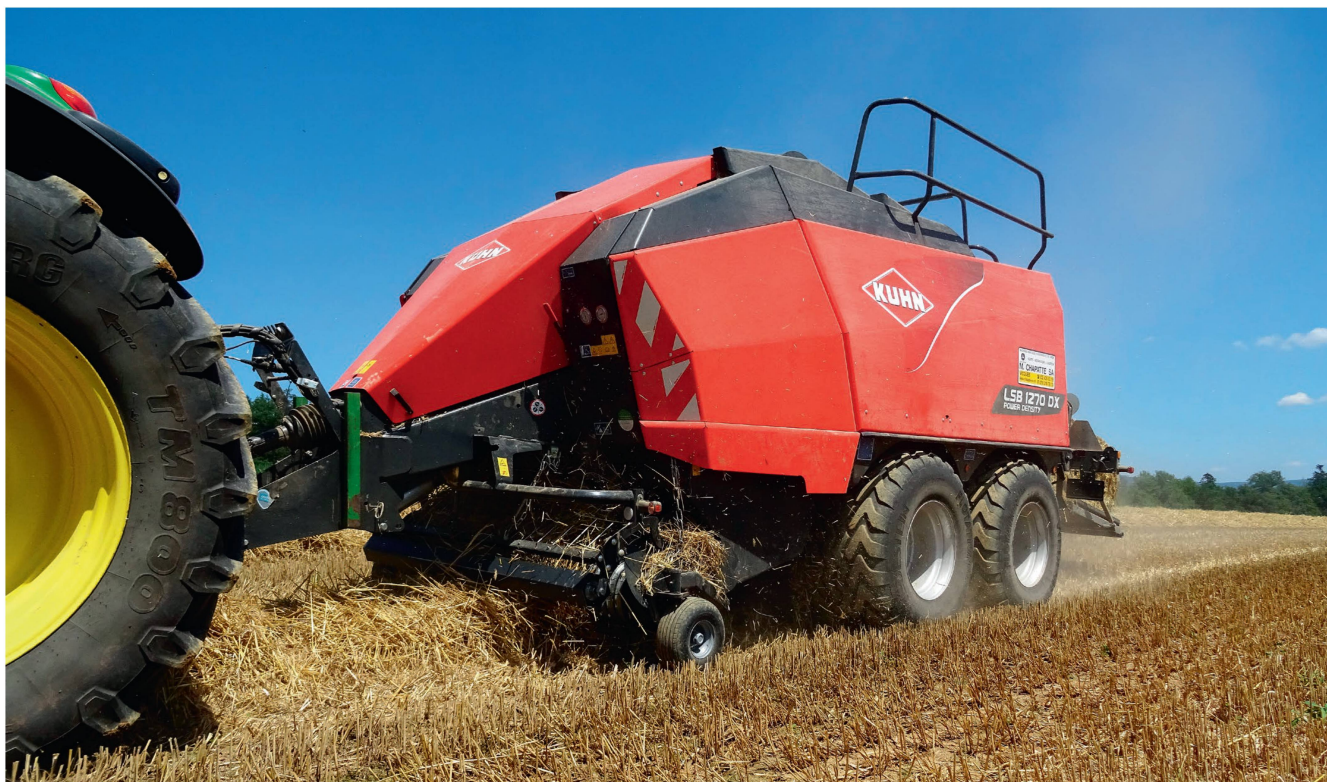
Die Quaderballenpresse «LSB 1270 DX» brachte Kuhn 2017 auf den Markt. Die Maschine ist für besonders «harte» Ballen mit Kanalmass 120x70 cm ausgerichtet. Bilder: R. Engeler
