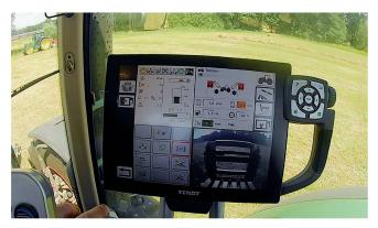
Die Bedienung der Isobus-kompatiblen Presse erfolgt übersichtlich über das Traktor-Terminal.
