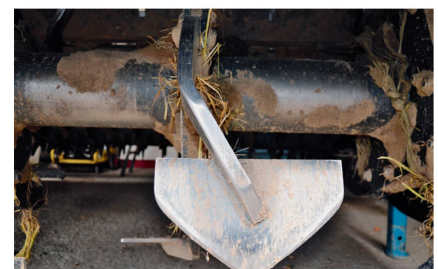
Der eigentliche «Spaten» ist mit einem versetzten Halter verschweisst.
