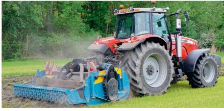
Der Antrieb erfolgt einseitig durch ein Stirnradgetriebe auf der rechten Maschinenseite. Als Nachläufer ist eine Zahnpackerwalze angebaut.
