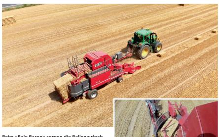
Beim «Bale Baron» sorgen die Ballenaufnahme mit Gummibändern sowie ein Drehteller für eine sehr flüssige Förderung der Kleinballen.
