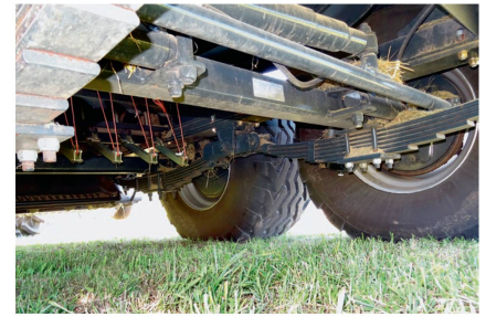
Dieses Modell ist mit einer nachlaufgelenkten und sperrbaren Tandemachse ausgestattet (Reifendimension 620/50-22.5).
