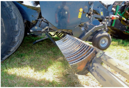
Die mit 23 Messern bestückte Kassette kann zu Wartungszwecken seitlich herausgezogen werden.
