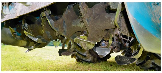
Das Modell «46-VX300» von Imants ist eine Spatenmaschine mit rotierender Welle. Bilder: R. Hunger
