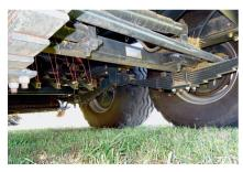
Dieses Modell ist mit einer nachlaufgelenkten und sperrbaren Tandemachse ausgestattet (Reifendimension 620/50-22.5).
