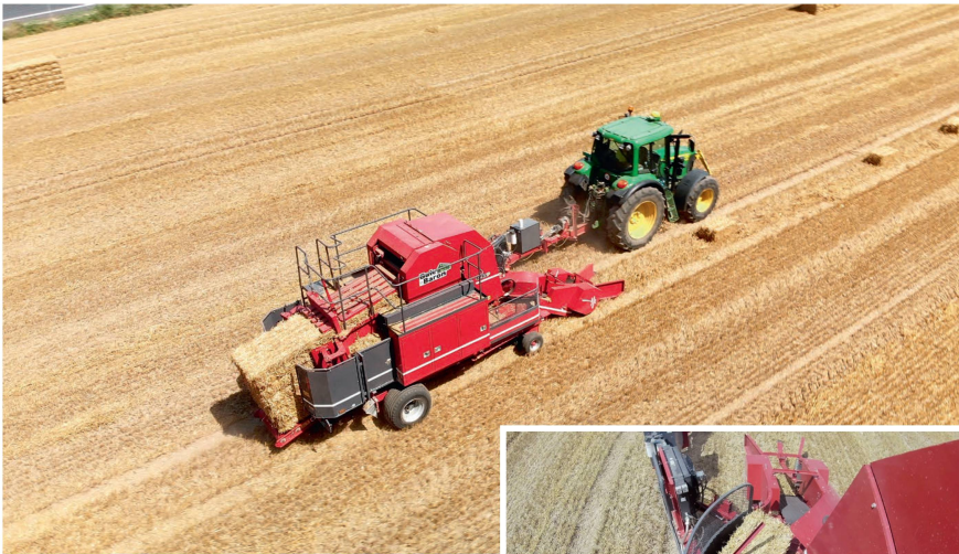
Beim «Bale Baron» sorgen die Ballenaufnahme mit Gummibändern sowie ein Drehteller für eine sehr flüssige Förderung der Kleinballen.
