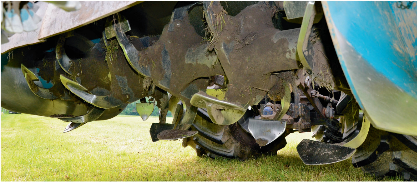
Das Modell «46-VX300» von Imants ist eine Spatenmaschine mit rotierender Welle. Bilder: R. Hunger
