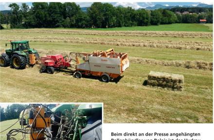
Beim direkt an der Presse angehängten Ballenbündler von Belair ist das Hydrauliksystem an einem Dreipunktbock mit Zapfwellendurchtrieb angebaut.
