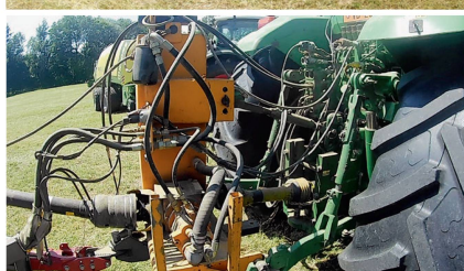
Beim direkt an der Presse angehängten Ballenbündler von Belair ist das Hydrauliksystem an einem Dreipunktbock mit Zapfwellendurchtrieb angebaut.
