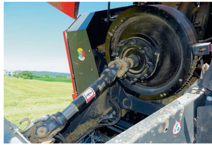
Sämtliche Antriebskomponenten, wie hier das Schwungrad, sind für hohen Durchsatz und hohe Dichte konstruiert.
