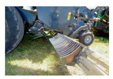
Die mit 23 Messern bestückte Kassette kann zu Wartungszwecken seitlich herausgezogen werden.
