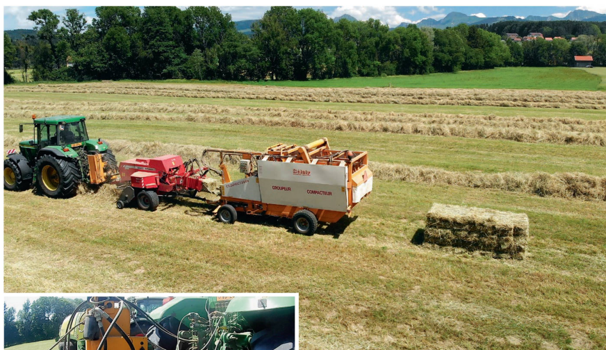
Beim direkt an der Presse angehängten Ballenbündler von Belair ist das Hydrauliksystem an einem Dreipunktbock mit Zapfwellendurchtrieb angebaut.
