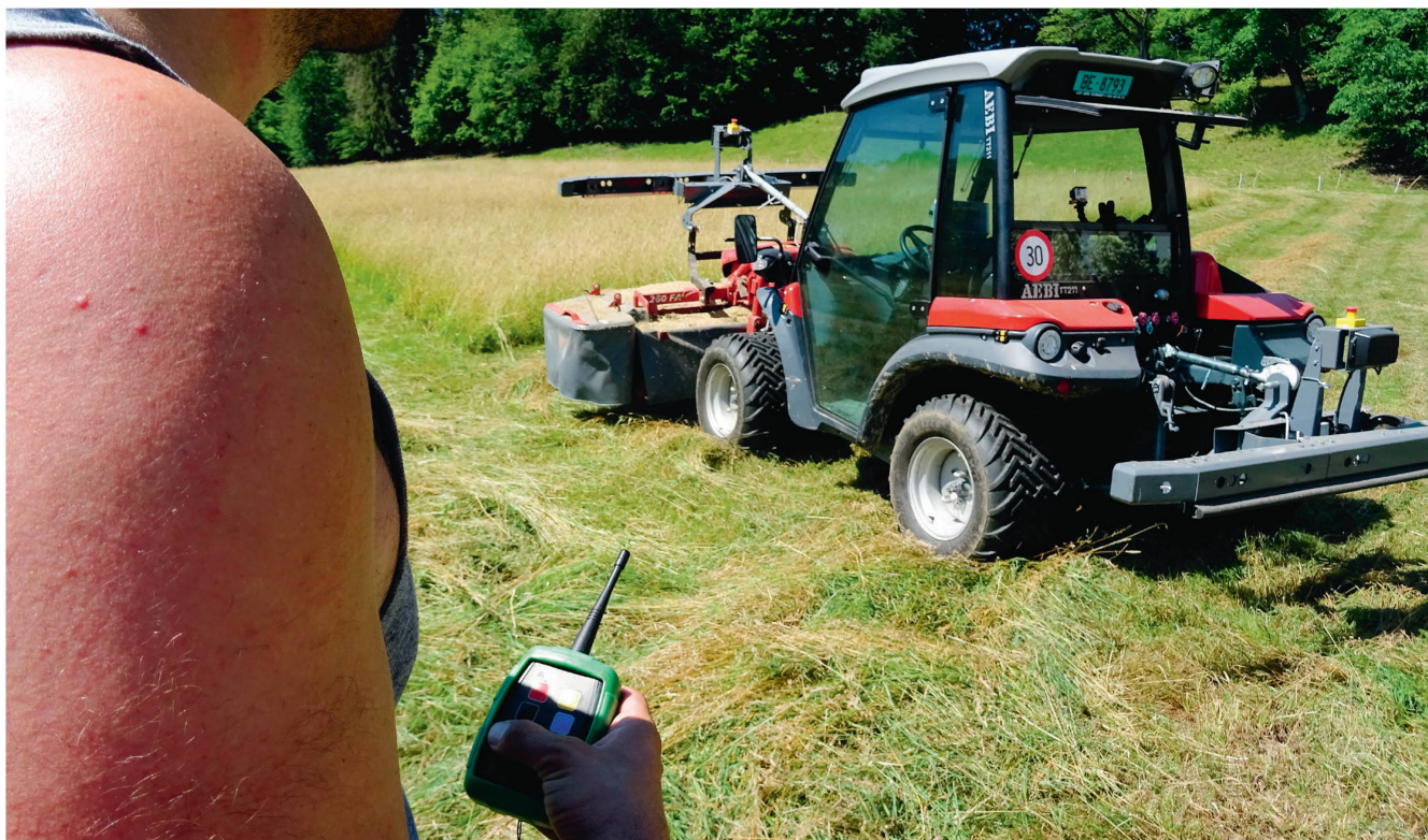
Der Aebi «TT 211» mäht auf dieser Parzelle das hoch stehende Gras selbständig. Die Bedienperson kann per Knopfdruck am kleinen Handgerät die Maschine starten und stoppen. Bilder: R. Engeler
