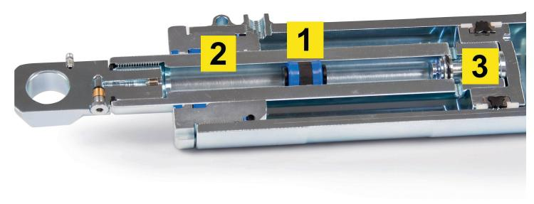
Schnittbild des Oberlenkers mit integrierter Dämpfung von GKN. Dämpferkolben (1); Dämpferkammer mit Stickstoff-Vorspannung (2) und Überströmkanal bei Druckanstieg (3). Bild: GKN (verändert Hunger)
