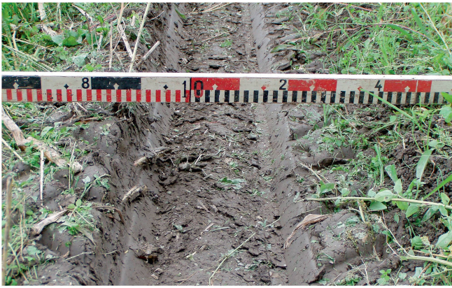
Bodenverdichtungen reduzieren das Wasserspeichungsvermögen im Boden.
