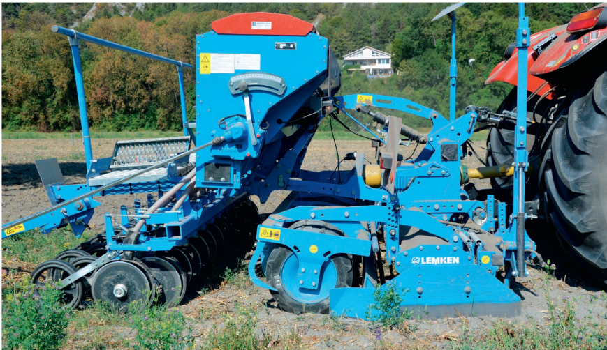
Aufgrund ihrer kompakten Bauweise eignet sich die Kreiselegge gut als Partner für die kombinierte Saat. Bild: R. Hunger
