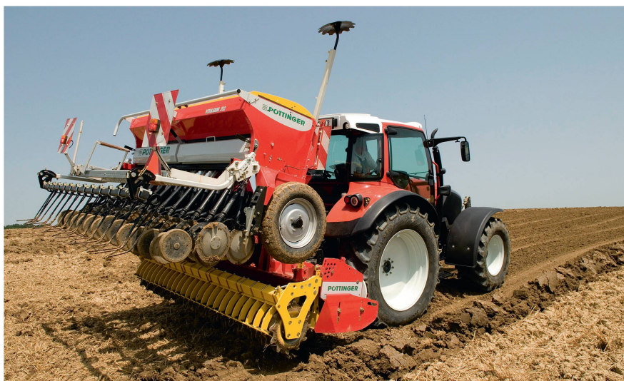
Angebaute Sämaschinen können für den Solo-Betrieb von der Kreiselegge getrennt werden.
