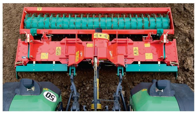
Die Kreiselegge nimmt unter den zapfwellengetriebenen Bodenbearbeitungsgeräten eine dominierende Stellung ein. Bild: Kverneland
