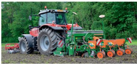
Im Bild eine Kombination aus Kreiselgrubber und Einzelkorn-Sätechnik. Bild: R. Hunger
