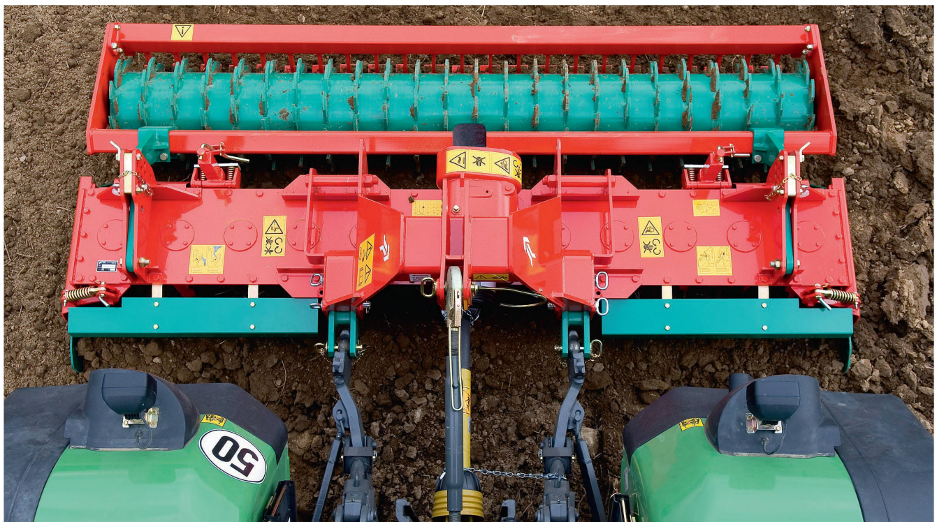
Die Kreiselegge nimmt unter den zapfwellengetriebenen Bodenbearbeitungsgeräten eine dominierende Stellung ein. Bild: Kverneland
