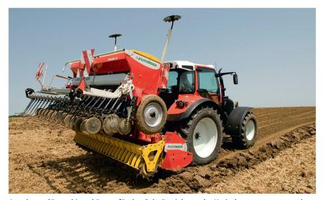
Angebaute Sämaschinen können für den Solo-Betrieb von der Kreiselegge getrennt werden. Bild: Pöttinger
