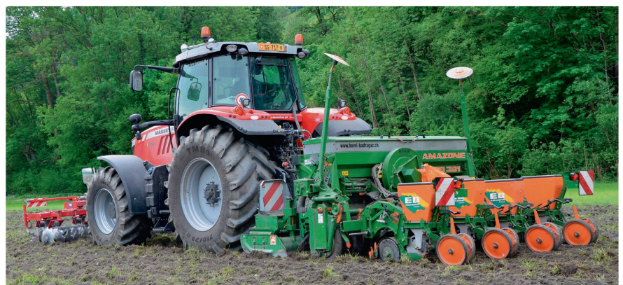
Im Bild eine Kombination aus Kreiselgrubber und Einzelkorn-Sätechnik. Bild: R. Hunger
