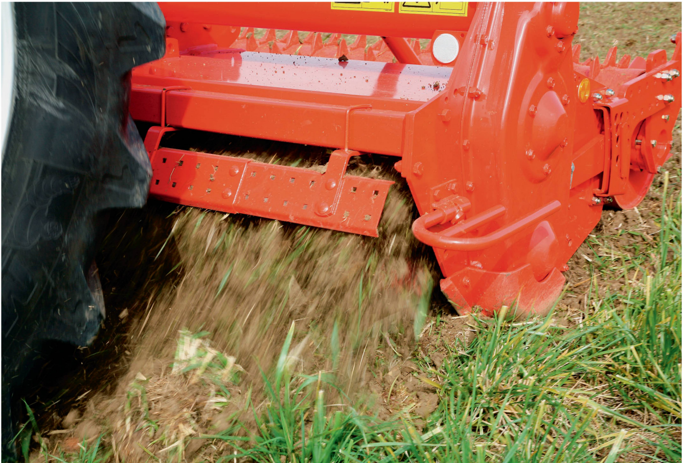
Rotorgeräte haben eine ausgeprägt mischende Arbeitsweise. Bild: Kuhn
