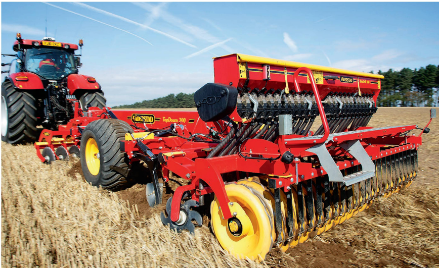
Zur Aussaat von Begrünungspflanzen und Zwischenfrüchten werden zunehmend «BioDrill»- oder «GreenDrill»-Systeme eingesetzt. Bild: Väderstad
