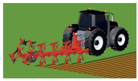
«Section Control» – eine Einzelkörper-Steuerung – schafft mehr Ordnung am Vorgewende.
