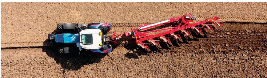
Wenn das «fünfte Rad» auch noch angetrieben wird, steigt die Energieeffizienz. Bild: ZF
