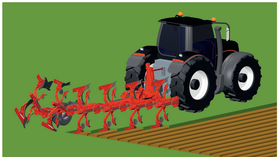
«Section Control» – eine Einzelkörper-Steuerung – schafft mehr Ordnung am Vorgewende.
