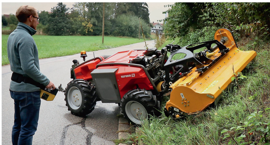
Der «Metron P48 RC», ein funkferngesteuerter Geräteträger von Reform (hier beim Mulchen einer Böschung) wird mit vier elektrischen Radmotoren angetrieben. Bild: zvg
