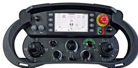
Bedient wird der Geräteträger über eine Funkfernbedienung mit integriertem, 4,3 Zoll grossem Farbdisplay.
