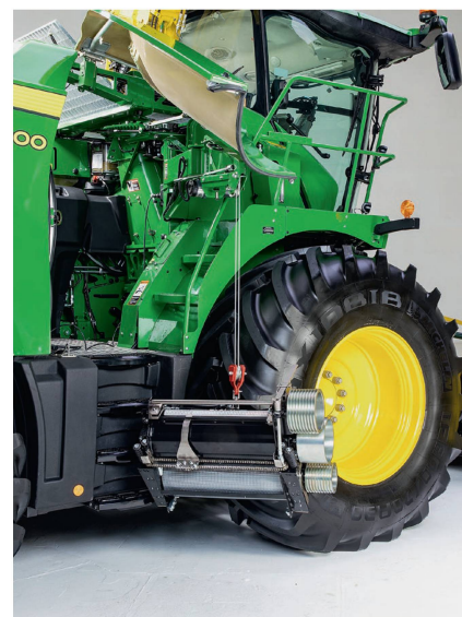
Der neu entwickelte «XStream KP»-Körnerprozessor arbeitet mit einem vergrösserten Rollendurchmesser von 250 mm.
