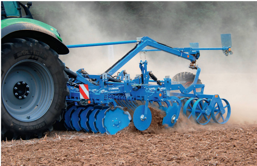
Die «Rubin 10» mit Unirad. Dieses mechanische Radsystem entlastet die Traktorhinterachse und soll für einen geringeren Hubkraftbedarf sorgen. Bilder: röt
