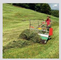
Rapid lanciert mit dem «Multi-Twister 190» einen weiteren Heu-, Grünfutterund Silageschieber. Wie die anderen Modelle, so kann auch das neue, ab Mai 2019 verfügbare Gerät mit einer Breite von 190 cm das Erntegut schonend aufnehmen und es im Hang oder in der Ebene durch die aktive Querförderung über das lastschaltbare Förderband wahlweise nach links oder rechts abtransportieren. Der «Multi-Twister 190» ist zu den Modellen des Einachsers «Monta» (bereits ab 14 PS) kompatibel.
