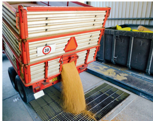
Die Heckmarkierungstafel deutet auf «Langsamverkehr» hin. Bild: R. Hunger
