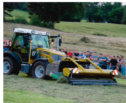
Pick-up-Frontbandschwader Knüsel «Air Swath 300-70»: 3 m Arbeitsbreite, 810 kg Gewicht, 80 PS Leistungsbedarf.
