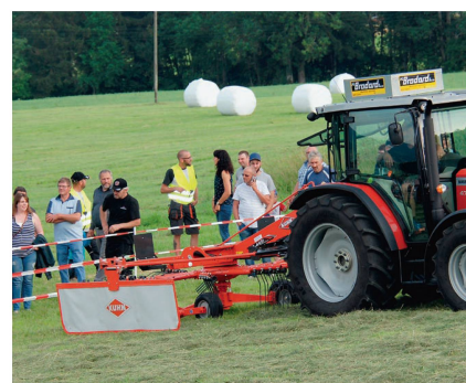
1-Kreisel-Schwader Kuhn «GA 4431»: 4,4 m Arbeitsbreite, 724 kg Gewicht, 30 PS Leistungsbedarf.
