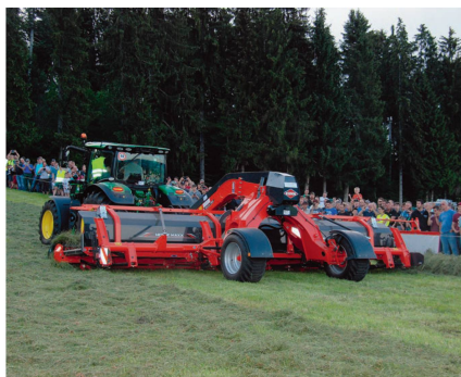
Pick-up-Bandschwader «Merge Maxx 950» von Kuhn: 9,50 m Arbeitsbreite, 4840 kg Gewicht, 85 PS Leistungsbedarf.
