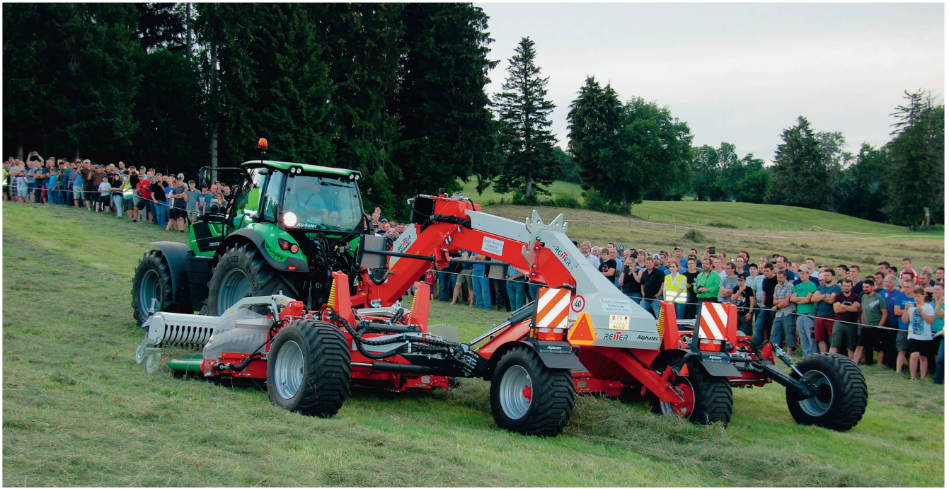
Pick-up-Bandschwader Reiter «Respiro R9»: 9 m Arbeitsbreite, 6400 kg Gewicht, 120 PS Leistungsbedarf. Bilder: H. Röthlisberger
