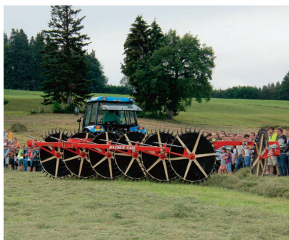
Sternradrechen Enorossi «Easy Rake 12»: 7,40 m Arbeitsbreite, 1430 kg Gewicht und 45 PS Leistungsbedarf.
