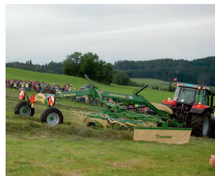
2-Kreisel-Schwader Krone «Swadro TS 680 Twin»: 6,8 bis 7,60 m Arbeitsbreite, 4270 kg Gewicht, 50 PS Leistungsbedarf.
