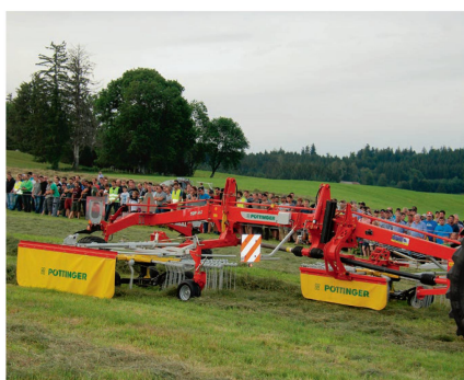
2-Kreisel-Schwader Pöttinger «Top 662»: 6,55 bis 7,30 m Arbeitsbreite, 1990 kg Gewicht, 60 PS Leistungsbedarf.
