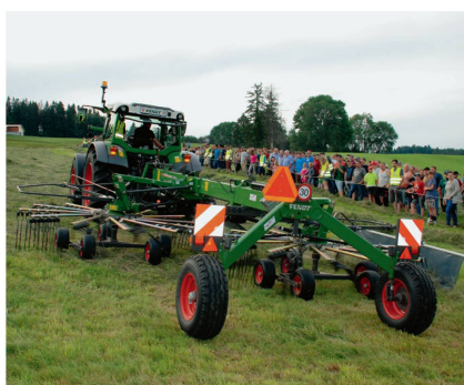
2-Kreisel-Schwader Fendt «Former 1452»: 5,8 bis 6,7 m Arbeitsbreite, 4270 kg Gewicht und 50 PS Leistungsbedarf.
