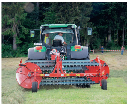
Kammschwader Repossi «74/51XL»: 4 m Arbeitsbreite, 580 kg Gewicht, 40 PS Leistungsbedarf.
