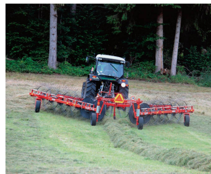
Sternradrechen Tonutti «Raptor V14 Pro AW»: 7,60 m Arbeitsbreite, 1300 kg Gewicht, 30 PS Leistungsbedarf.
