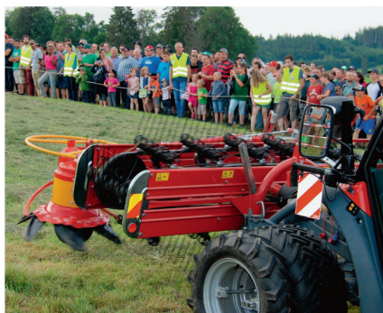
Frontbandrechen Molon «Super 230»: 2,3 m Arbeitsbreite, 255 kg Gewicht, 25 PS Leistungsbedarf.
