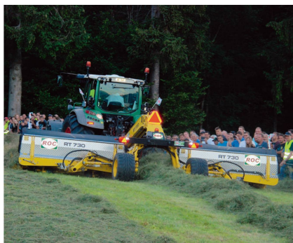
Pick-up-Bandschwader ROC «RT 730»: 7,30 m Arbeitsbreite, 3196 kg Gewicht und 100 PS Leistungsbedarf.
