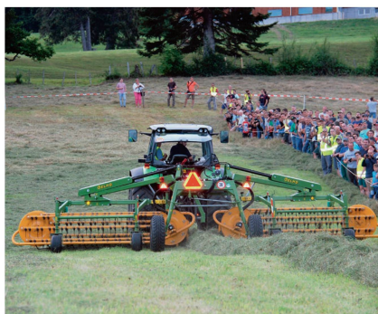
Kammschwader Elho «Twin 750»: 3 bis 7,50 m Arbeitsbreite, 2100 kg Gewicht und 70 PS Leistungsbedarf.
