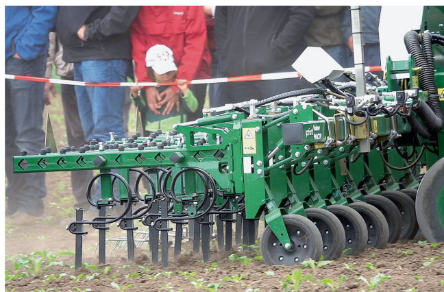
Die wohl auffälligste Besonderheit am Gerät von Garford ist die automatische Teilbreitenschaltung.
