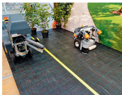
Hauerts Baumschulroboter versetzt keine Berge, dafür automatisch Töpfe und kann mit einem Dünger-Dispenser kommunizieren.
