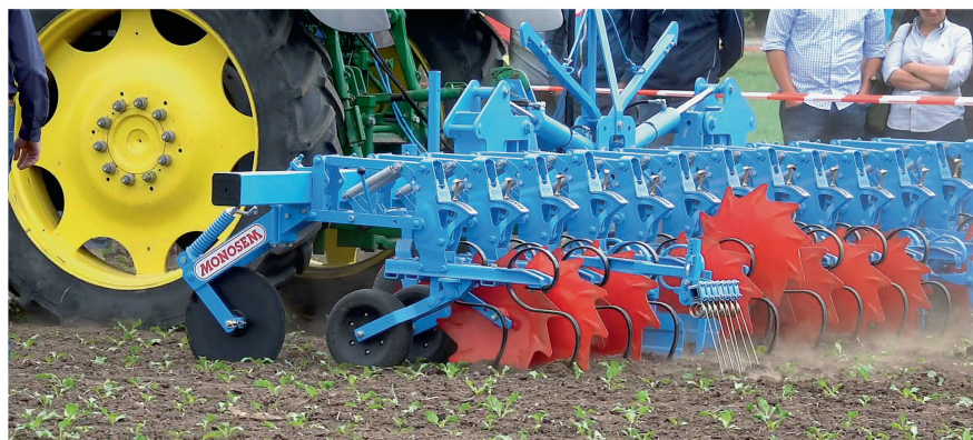
Das «Multicrop» von Monosem ist dank des grossen Abstands zwischen Boden und Tragrahmen von 70 cm auch für späte Einsätze geeignet.
