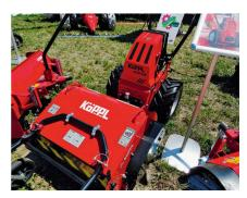
Köppls kompakter Einachser mit Elektromotor, 48-V-Akku-Antrieb und optimierter Leistungssteuerung kann bis zu 3 Stunden arbeiten.
