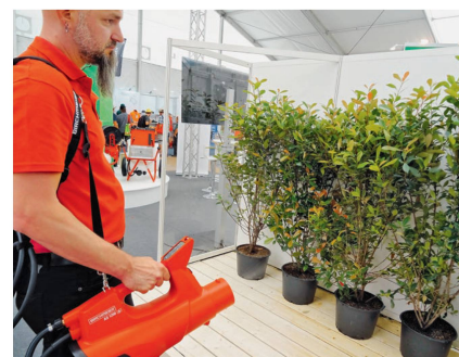
Ein tragbares akkubetriebenes Gebläse für die Rückenspritzen von Birchmeier kann den Sprühnebel von 0,5 bis 15 m optimal verteilen.
