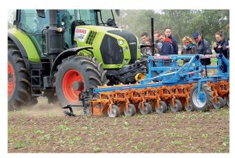
Ergonomischer und günstiger Frontanbau bei Schmotzer – optional mit Kamerasteuerung erhältlich. Bilder: R. Burkhalter
