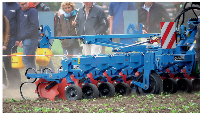
Jedes Hackelement beim Gerät von Carre ist am Tiefenführungsrad mit einer Spindelverstellung und gut sichtbarer Skala ausgestattet.
