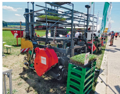
«Plant Tape» von Jampen Landmaschinen und Swiss Plant ist ein integriertes System von der Aussaat eines Saatbandes bis hin zum Setzen im Freiland.
