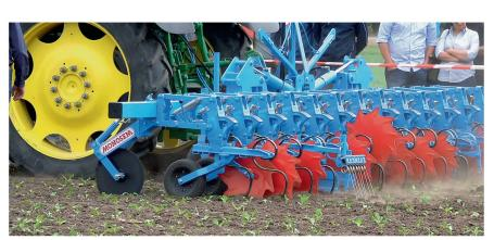
Das «Multicrop» von Monosem ist dank des grossen Abstands zwischen Boden und Tragrahmen von 70 cm auch für späte Einsätze geeignet.
