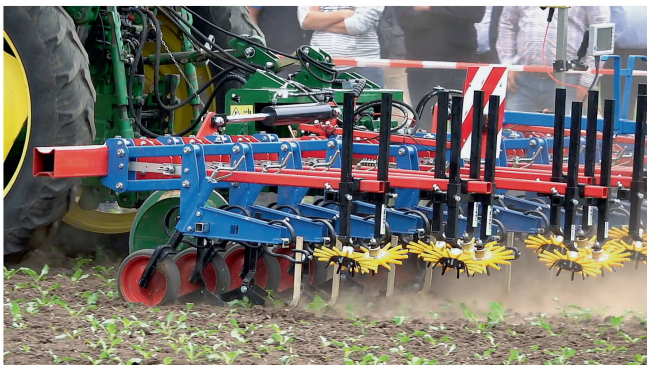
Das Hacksystem «Habicht» von Kress präsentierte sich mit Kamera-technik und Verschieberahmen von Garford.
