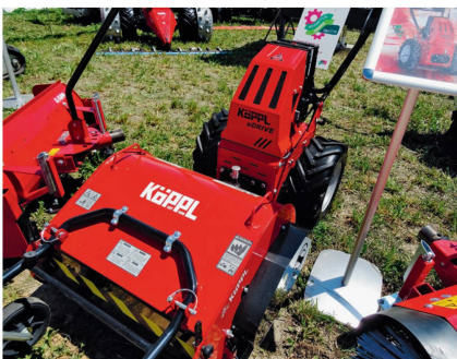
Köppls kompakter Einachser mit Elektromotor, 48-V-Akku-Antrieb und optimierter Leistungssteuerung kann bis zu 3 Stunden arbeiten.
