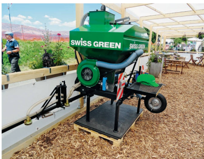
Der hydropneumatische Düngerstreuer von Swiss Green für die exakte Applikation von Nährstoffen und Übersaaten von Rasen.
