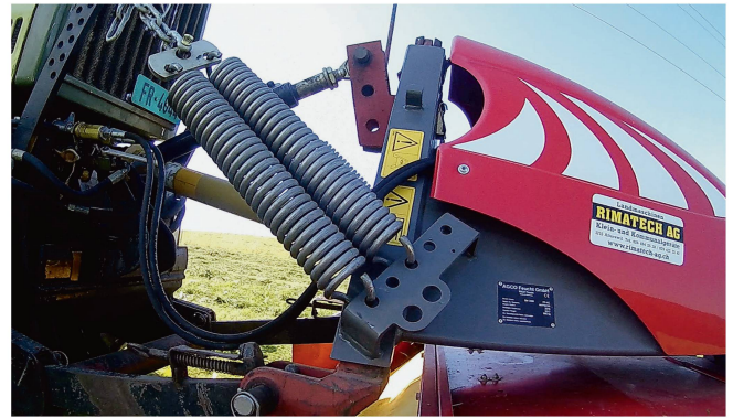
Die Entlastungsfedern (in Arbeitsstellung) sollten in einem Winkel von 45° zum Boden stehen.
