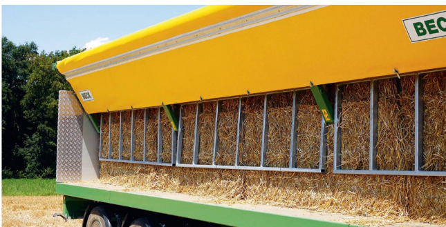
Mit dem System können auch Ladungen formschlüssig gesichert werden, wenn diese nicht bis an den Rand der Ladefläche reichen.
