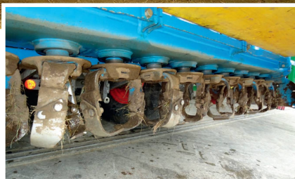
Für die Kreiselegge «Zirkon 10» von Lemken wurden spezielle Arbeitswerkzeuge konstruiert, mit denen der Boden in einer bestimmten Tiefe abgehobelt werden kann.
