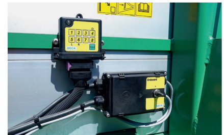
Die Bedienung erfolgt über eine Funkfernsteuerung, wenn diese fehlt über eine Onboard-Bedienung.
