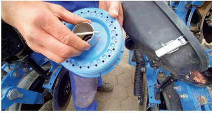
Zentrales Element der «Azurit»-Technik: Die Vereinzelungseinheit mit den zwei synchronisierten Lochscheiben links- und rechtsseitig.
