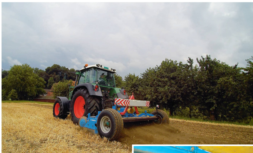
Für die Kreiselegge «Zirkon 10» von Lemken wurden spezielle Arbeitswerkzeuge konstruiert, mit denen der Boden in einer bestimmten Tiefe abgehobelt werden kann.
