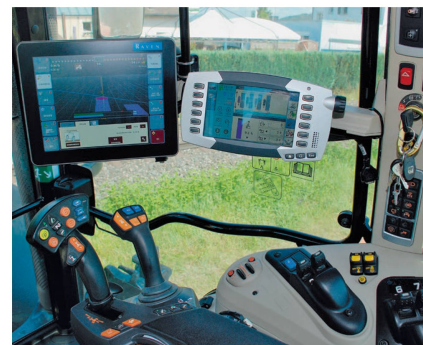
Der Arbeitsplatz im MF des Betriebs Rathgeb mit Fahrhebel, Joystick, Datatronic-Terminal und dem GPS-System von Hersteller SBG (oben links).
