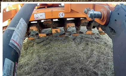
Die Schälfräse von Falc gibt es in Arbeitsbreiten von 3 bis 6 m und wurde speziell für die oberflächliche Bearbeitung des Wurzelhorizonts optimiert. Bilder: R. Burkhalter und R. Engeler
