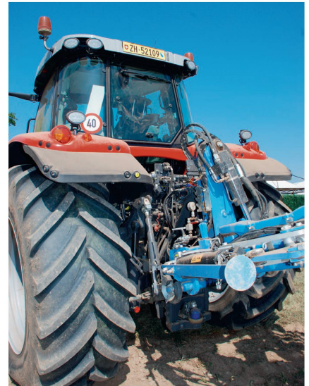
Am Heck hebt der Traktor 9600 kg. Dazu gibt es fünf Steuergeräte, ABS-Steckdose sowie ein pneumatisches Zweileiter- wie auch ein hydraulisches Einleiter-Bremssystem.
