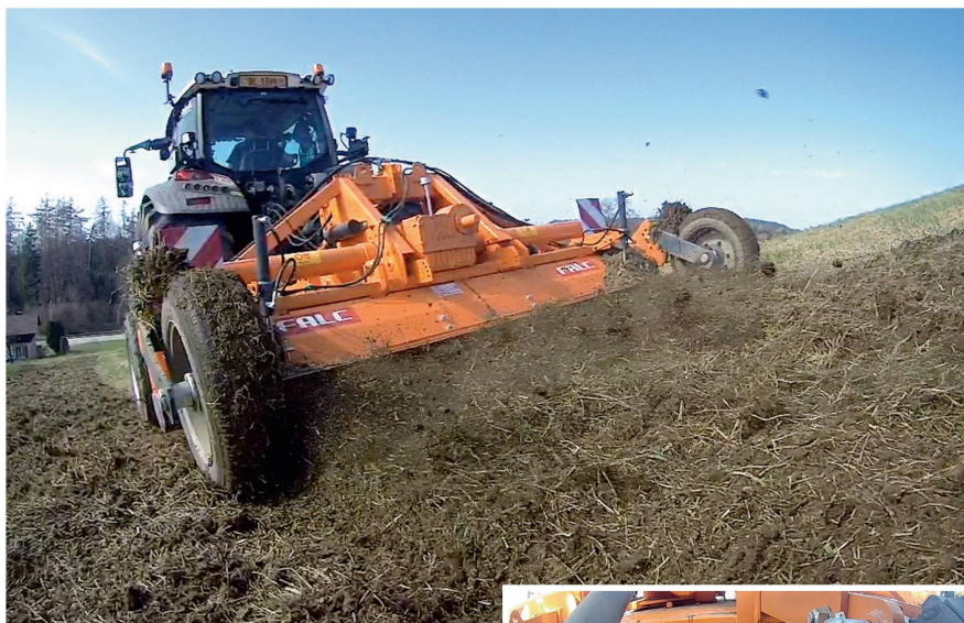
Die Schälfräse von Falc gibt es in Arbeitsbreiten von 3 bis 6 m und wurde speziell für die oberflächliche Bearbeitung des Wurzelhorizonts optimiert. Bilder: R. Burkhalter und R. Engeler
