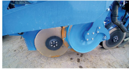
Doppelscheibenscharen schaffen Platz für die Unterfussdüngung, Trapezpackersegmente sorgen für die Vorverfestigung der beiden Saatzeilen.
