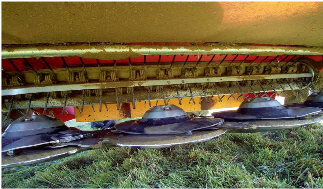
Sechs paarweise gegeneinander laufende Scheiben führen das Futter in drei Mini-Schwaden dem Aufbereiter zu.
