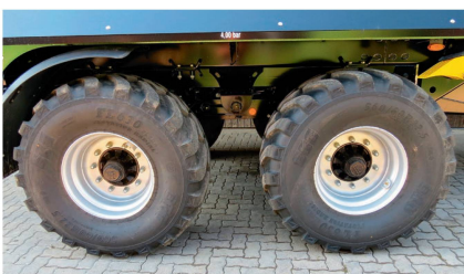
Das Tandemfahrwerk mit Nachlaufkackse passt super und ist auch auf der Strasse gut zu fahren.
