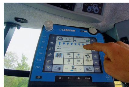
Vor Beginn der Aussaat werden am Isobus-Bedienterminal die Grundeinstellungen für die Saat und für die Vereinzlung festgelegt.
