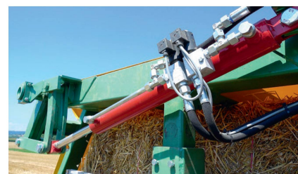
Jeder Hydraulikzylinder ist an einer Ringleitung angeschlossen und mit einem elektronisch betätigten Ventil ausgerüstet.
