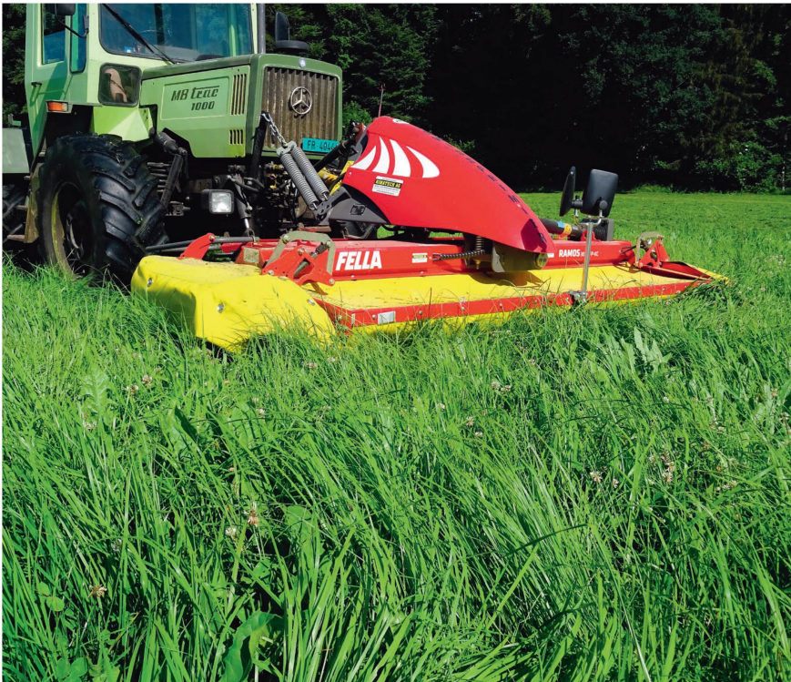
Das Front-Scheibenmähwerk mit Zinken-Aufbereiter «Ramos 3060» von Fella präsentierte sich als leichtes und leichtzugesiges Gerät. Bilder: R. Engeler
