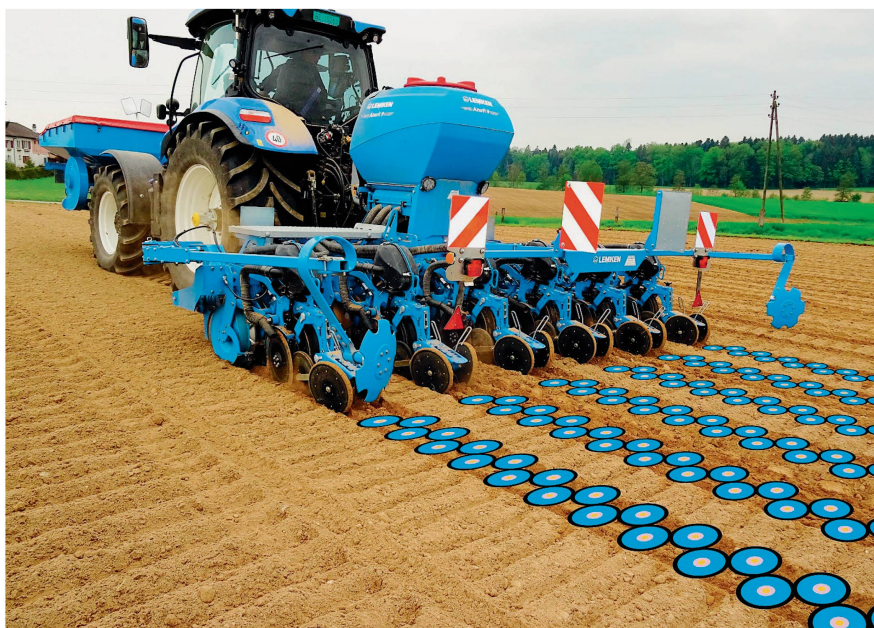
6-reihige, 4,5 m breite und klappbare Variante der «Azurit 9» mit einem Modul für die Unterfussdüngung. Die beiden Saatzeilen haben einen Abstand von 12,5 cm. In Längsrichtung wird alle 14,8 cm ein Korn abgelegt, einmal links, einmal rechts. Bilder: R. Engeler
