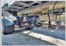
**Bild links:** Fliegl-Abschiebewagen mit Treibachssystem «FSA» (Fliegl Self-propelled-axle). Die Stromabnahme für den Antrieb erfolgt über eine Steckdose am Traktor.
