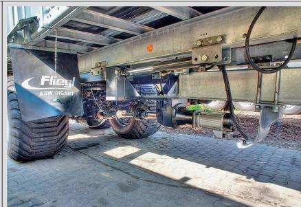
**Bild links:** Fliegl-Abschiebewagen mit Treibachssystem «FSA» (Fliegl Self-propelled-axle). Die Stromabnahme für den Antrieb erfolgt über eine Steckdose am Traktor.
