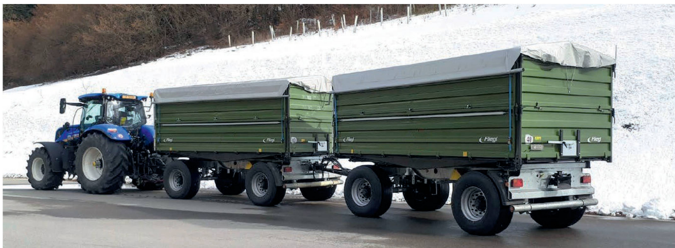
Der Test-Anhängerzug: Traktor New Holland «T7.270» mit hydraulischer Zweileiter-Bremse ab Werk und zwei Drehschemel-Anhänger Fliegl «DK180» (je 18 t zulässiges Gesamtgewicht) mit aufgebautem «H2L»-Bremsssystem von Paul Forrer. Bild: Paul Forrer AG
