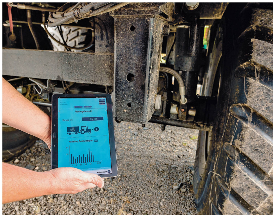
Vom Radkasten aufs Tablet oder Smartphone – per kabellose Kommunikation leitet «Agro Hub» die gemessenen Daten weiter.
