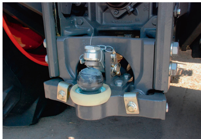
Die Kugelkopfkupplung ist in den letzten Jahren stark aufgekommen. Vorteile sind die tiefe Anhängemöglichkeit sowie die grossflächige und spielfreie Verbindung von Anhänger und Traktor.
