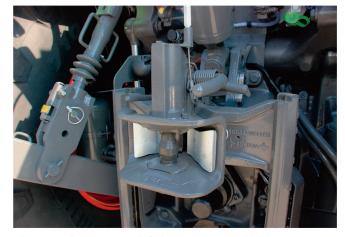
Die Zugmaulkupplung ist einfach zum Nutzen und leicht zum Ankuppeln. Bolzen und Öse haben aber immer Spiel. Das führt zu erhöhtem Verschleiss.
