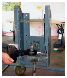
Piton-Fix-Kupplung: Von Vorteil ist die tiefe Anhängemöglichkeit, von Nachteil, dass der Anhänger auf die Kupplung mithilfe eines Stützrades herabgelassen werden muss.
