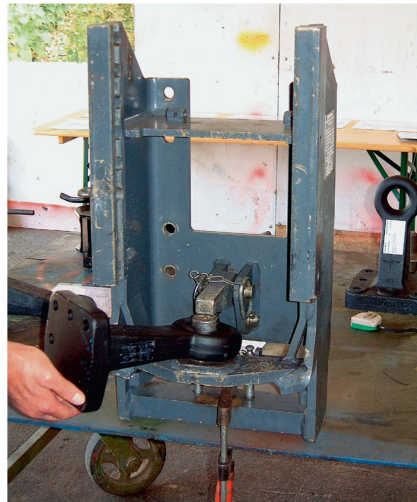
Piton-Fix-Kupplung: Von Vorteil ist die tiefe Anhängemöglichkeit, von Nachteil, dass der Anhänger auf die Kupplung mithilfe eines Stützrades herabgelassen werden muss.
