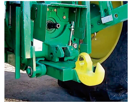
Der Hitchhaken hat sich bei uns nicht durchgesetzt. Von Nachteil ist die geringe Kontaktfläche zur Zugöse, was zu erheblichem Verschleiss führen kann.
