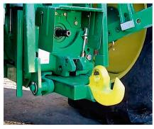
Der Hitchhaken hat sich bei uns nicht durchgesetzt. Von Nachteil ist die geringe Kontaktfläche zur Zugöse, was zu erheblichem Verschleiss führen kann.
