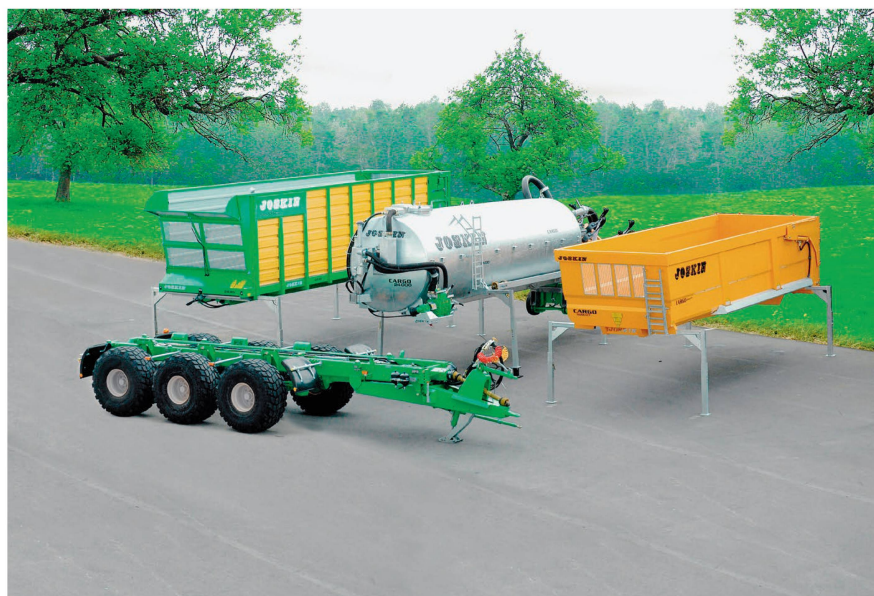
Durch den Einsatz mehrerer Aufbauten lässt sich das Fahrwerk, sowohl beim Wechselfahrgestell als auch beim Hakenliftanhänger, ganzjährig auslasten. Bilder: Joskin
