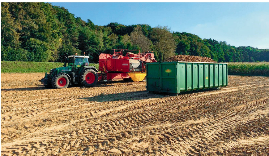
Hakenliftanhänger eignen sich vor allem bei Arbeiten, bei denen die Aufbauten stationär befüllt werden müssen. Bilder: R. Fonk
