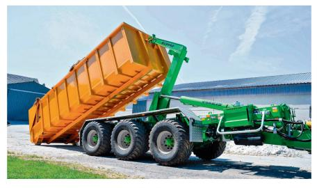
Dem Aufzugswinkel ist bei einem Hakenliftanhänger unbedingt Rechnung zu tragen. Schüttgüter wie Raps beginnen schnell zu fliessen und können so über die Wände der Mulde überschwappen.
