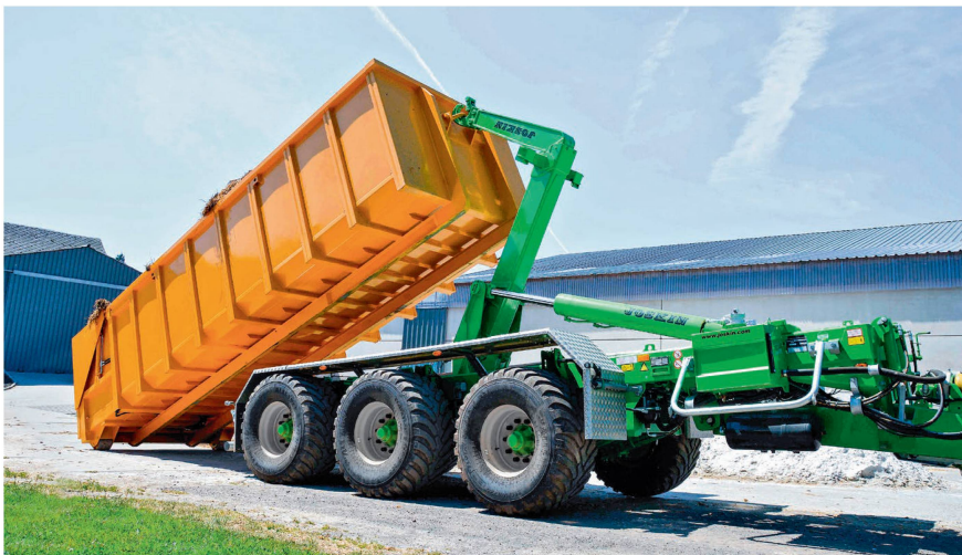
Dem Aufzugswinkel ist bei einem Hakenliftanhänger unbedingt Rechnung zu tragen. Schüttgüter wie Raps beginnen schnell zu fließen und können so über die Wände der Mulde überschwappen.
