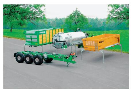
Durch den Einsatz mehrerer Aufbauten lässt sich das Fahrwerk, sowohl beim Wechselfahrgestell als auch beim Hakenliftanhänger, ganzjährig auslasten. Bilder: Joskin
