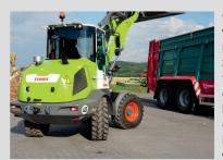
Claas nimmt in der Kooperation mit Liebherr weitere Radlader in das Programm auf. Die drei neuen «Torion»-Modelle tragen die Zusatzbezeichnung «Sinus», weil sie dank einer Kombination von Knicklenkung (allerdings dann 30° statt 40°) und Achsschenkellenkung hinten (25°) einen harmonisch engen Wenderadius ermöglichen, der um 10 % geringer als bei den rein knickgelenkten Maschinen ist. Die Hinterachslenkung wird durch eine mechanische Verbindung zwi-
