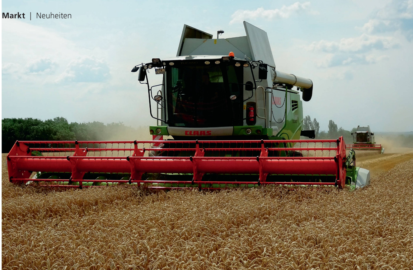
Das Modell «Tucano 580» mit dem «APS Hybrid»-Dreschsystem rundet künftig diese Baureihe nach oben ab. Bilder: R. Engeler
