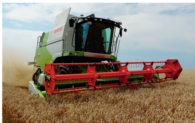
Die Mähdrescher vom Typ «Tucano» werden nun auch hangtauglich und können – wie hier beim Modell «Tucano 560» – Neigungen bis 18 % ausgleichen.
