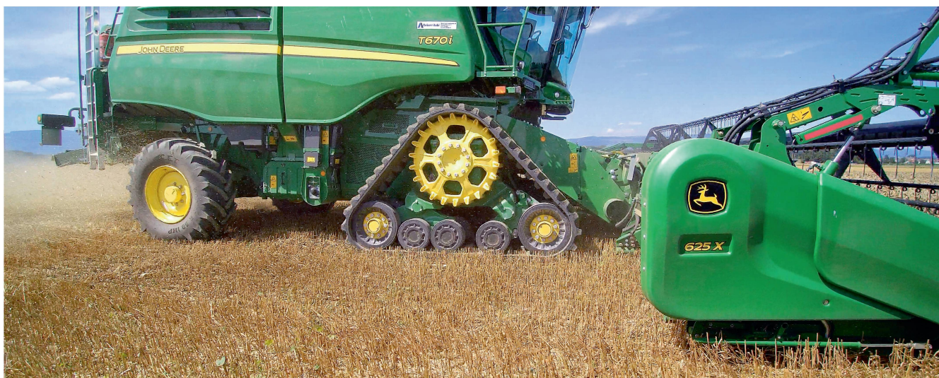
Bei den neuen Raupen soll die fünffache Lagerung zu wesentlich mehr Fahrkomfort im Mähdrescher führen. Bild: R. Engeler
