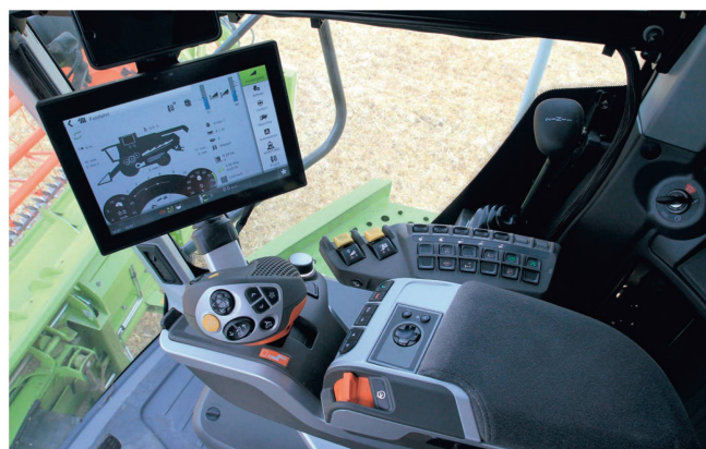
Das Bedienterminal «Cebis» wurde für die Baureihe «Tucano» überarbeitet. Man kann nun per Touchscreen oder Schalter auf der Armlehne die Funktionen verstellen. Bild: J. Paar
