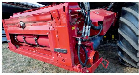
Der Schrägförderer wurde verstärkt und mit einer optionalen Neigungsvorrichtung ausgerüstet.
