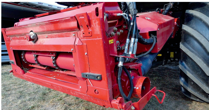
Der Schrägförderer wurde verstärkt und mit einer optionalen Neigungsvorrichtung ausgerüstet.
