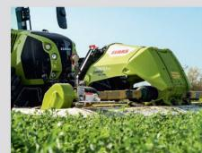
Claas erweitert mit «Disco 3600 Move» und «Disco 3200 Move» in Varianten mit und ohne Aufbereiter die Baureihe seiner Front-Scheibenmähwerke um sechs neue Modelle. Die Konstruktion erlaubt dank dem neu entwickelten Anbaubock eine Bewegungsfreiheit von 1000 mm unabhängig von den Unterlenkern der Fronthydraulik für eine optimale Bodenanpassung des Mähbalkens. Die neuen Mähwerke sind in 3,0 m und 3,4 m Arbeitsbreite ohne Aufbereiter sowie optional mit Zinken- oder Walzenaufbereiter erhältlich.
