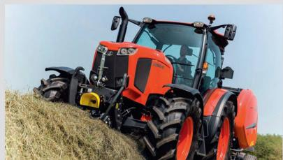
6100 kg im Heck. Die Hydraulikpumpe soll je nach Option 76,3 oder 82,5 l/min leisten. Motorseitig kommen Aggregate der Typen «V6108» (4 Zylinder, 6,1 l) und «V3800» (4 Zylinder, 3,8 l) zum Einsatz. Neu ist weiter eine Funktion beim Wendemanöver, die mit Sensoren in der Vorderachse arbeitet und den Allradantrieb beim Wenden automatisch abschaltet, um einen optimalen Wenderadius bei maximaler Vorgewende- und Reifenschonung zu gewährleisten.
