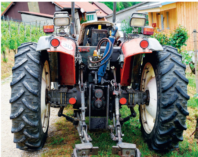
Durch Kehren der Hinterräder dehnt sich die Spurbreite des Carraro von 1,1 auf 1,5 m aus.
