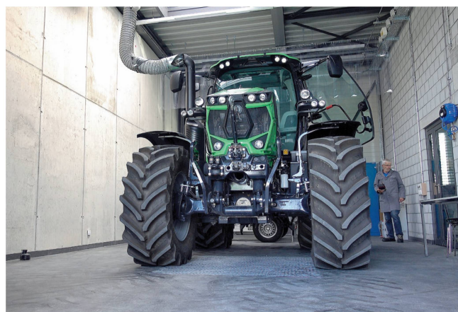
Integriert ist auch ein neuer Traktorenprüfstand, mit dem nun Leistungen bis 300 PS analysiert werden können.
