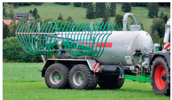
Mit grossvolumigen Reifen und einem Reifendruck von rund einem bar lässt sich bodenschonend und dieselsparend Gülle ausbringen. Bild: R. Engeler
