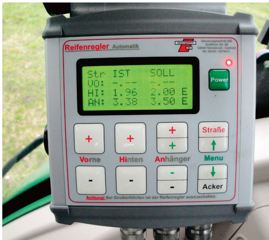
Beispiel einer digitalen Universalsteuerung, die sowohl den Reifendruck des Traktors als auch des Anhängers steuern kann. Bild: L. Volk
