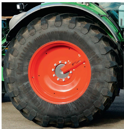
Fendt bietet mit «Vario-Grip» ab Werk eine integrierte Reifendruckanlage für Gross-traktoren an. Ein Assistenzsystem macht den Fahrer auf zu niedrigen oder zu hohen Druck aufmerksam. Bild: T. Gläser
