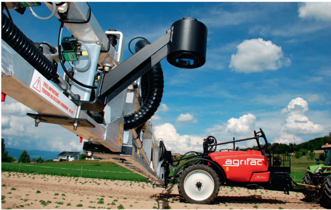
Mit Schallwellen wird der Abstand zur Pflanze gemessen. So ist jederzeit ein optimaler Abstand zur Pflanze gewährleistet.
