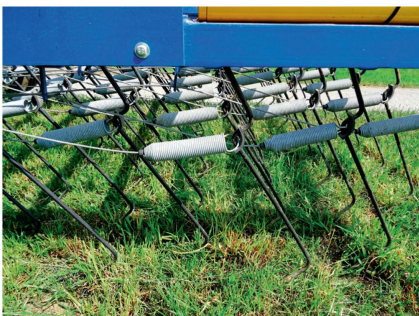
Der Druck jedes einzelnen Zinkens wird durch die Spannung der Zugfedern erzeugt.
