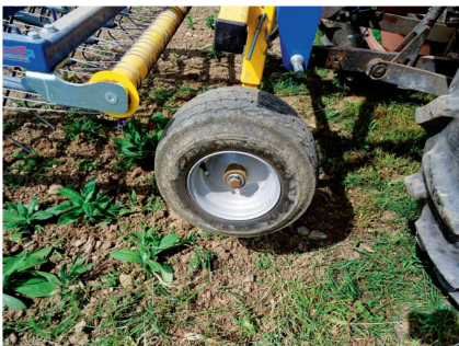
Die Tiefenführung erfolgt über zwei Stützräder vorne, die entlang einer Lochschiene in sechs Positionen verstellt werden können.
