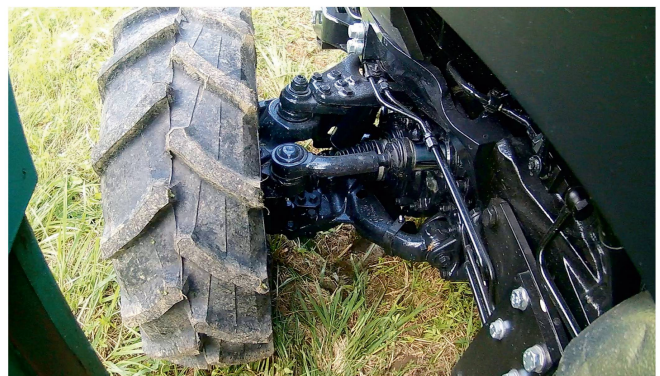
Optional gibt es eine gefederte Vorderachse mit elektronisch gesteuerter Einzelradaufhängung.
