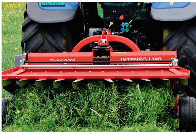
Dank Leitblech erfolgt die Ablage gleichmässig und locker.
