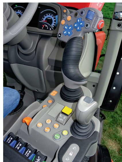
Über die innovative Bedienarmlehne «MaxCom» lassen sich fast alle Funktionen per Joysticks steuern. Bilder: R. Engeler
