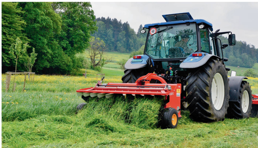
Die Kombination aus Frontmähwerk und Heckaufbereiter sorgt am Hang für ideale Gewichtsverteilung. Bilder: R. Hunger
