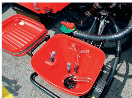
Serienmässig gibt es eine leistungsfähige Einspülschleuse mit kurzen Leitungswegen.
