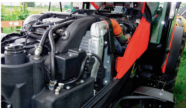
Bei der Baureihe «Frutteto» kommen hauseigene «Farmotion»-Motoren mit 3 oder 4 Zylindern zum Einsatz.
