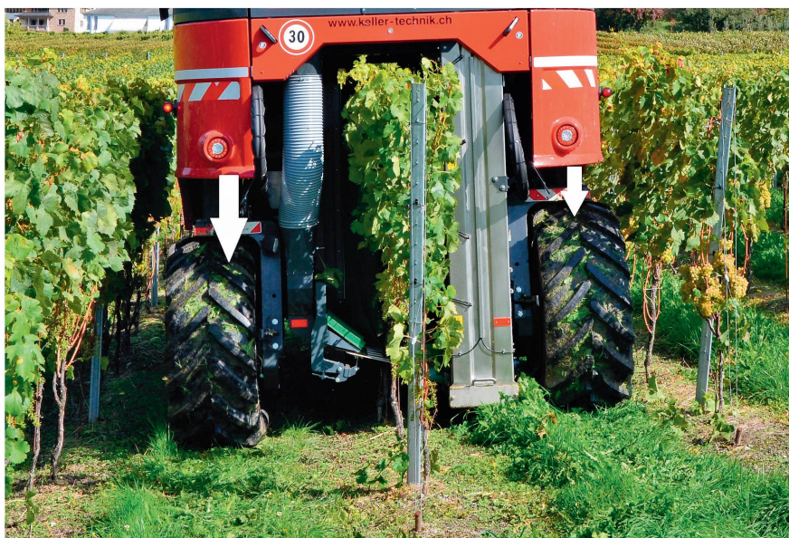
Ein automatischer Seitenhangausgleich führt die Maschine horizontal durch die Rebzeile.
