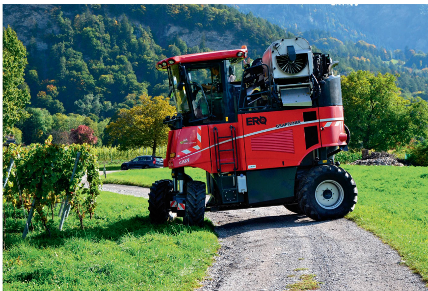
Dank 90°-Lenkeinschlag verfügt der Traubenvollernter über eine beeindruckende Wendigkeit.
