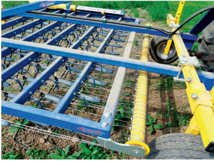
Der Zinkendruck kann hydraulisch und zentral über Drahtseile, die vorne an einer drehbaren Welle befestigt sind, entlang einer Skala (oben im Bild) verstellt werden.
