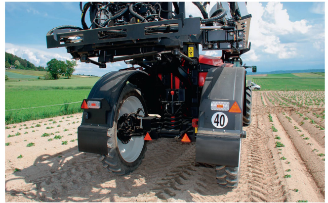
Die grosszügige Zentral-Spiralfeder sorgt für guten Fahrkomfort. Die gelenkte Achse kann für die Strassenfahrt gesperrt werden.
