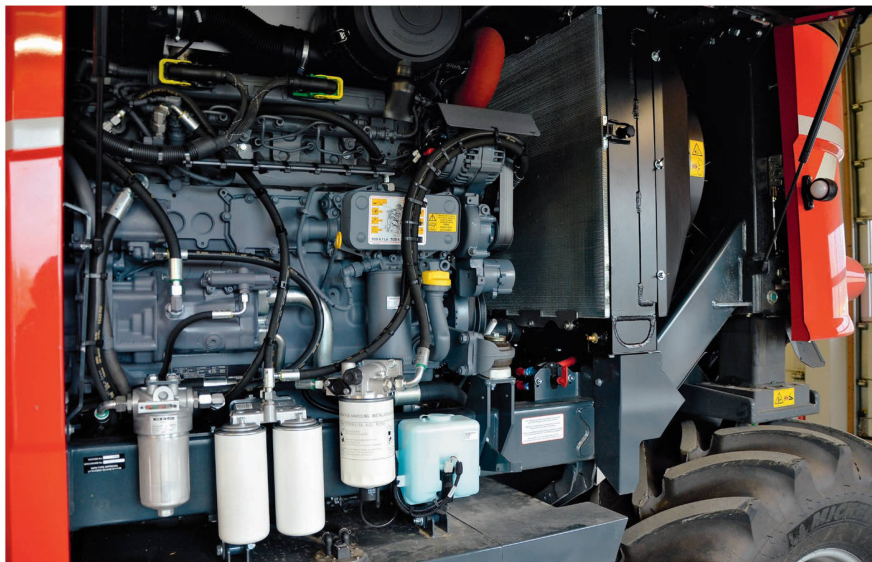
Zum «Grapeliner» gibt es vier Motorvarianten mit 114, 120, 129 oder 150 kW – alle von Deutz.
