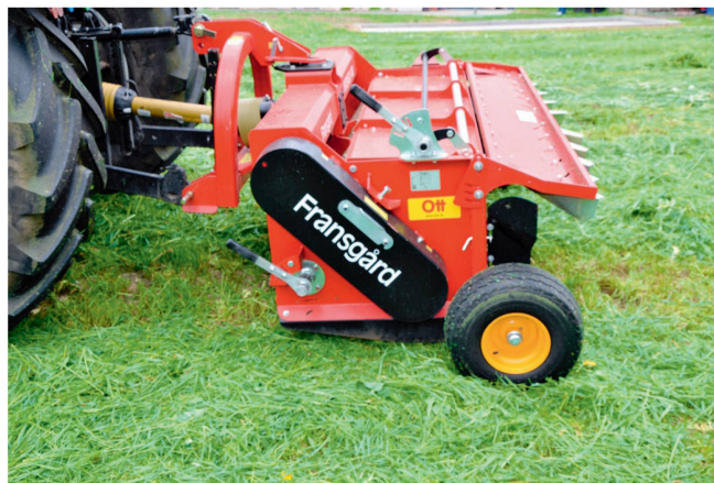
Die Aufbereitungsintensität wird links an der Maschine eingestellt.
