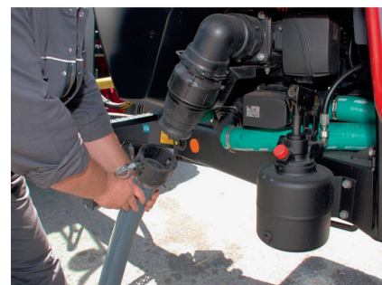
Die serienmässige Membrankolbenpumpe schöpft 500 Liter Wasser pro Minute.
