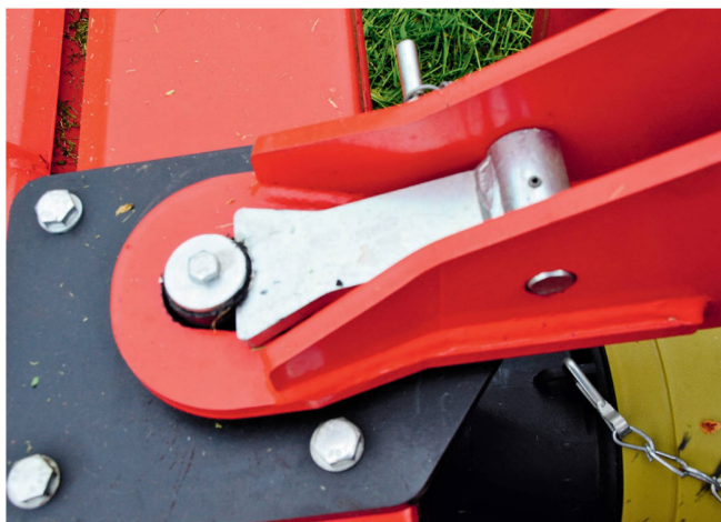
Wichtiges Detail am Hang: die Schwenkbockverriegelung sorgt für spurtreuen Nachlauf.
