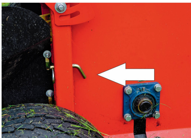
Die Aufnahmetiefe kann über das Fahrwerk (und den Oberlenker) eingestellt werden.
