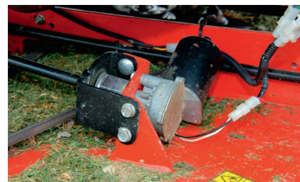
Elektromotoren für die Höheneinstellung des Mähwerks sind praktisch. Ärgerlich ist es, wenn sie ihren Dienst verweigern.
