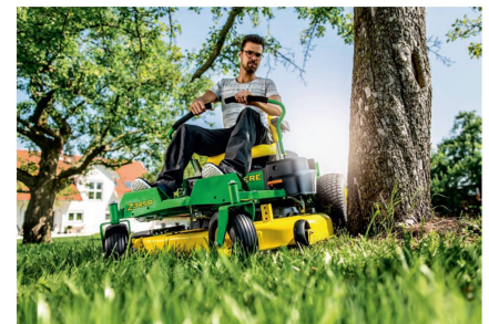
Extrem wendig: Mit Zero-Turn-Mähern kann man um Bäume herum navigieren, ohne anzuecken. Gesteuert wird mit Hebeln.
