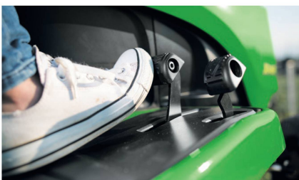
Der Hydrostat-Antrieb über das Fusspedal bietet für den Fahrer den grösstmöglichen Komfort.
