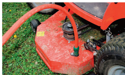
Praktisch: Das Mähwerk kann bei diesem Rasenmäher mit einem Wasserschlauch-Anschluss gereinigt werden.
