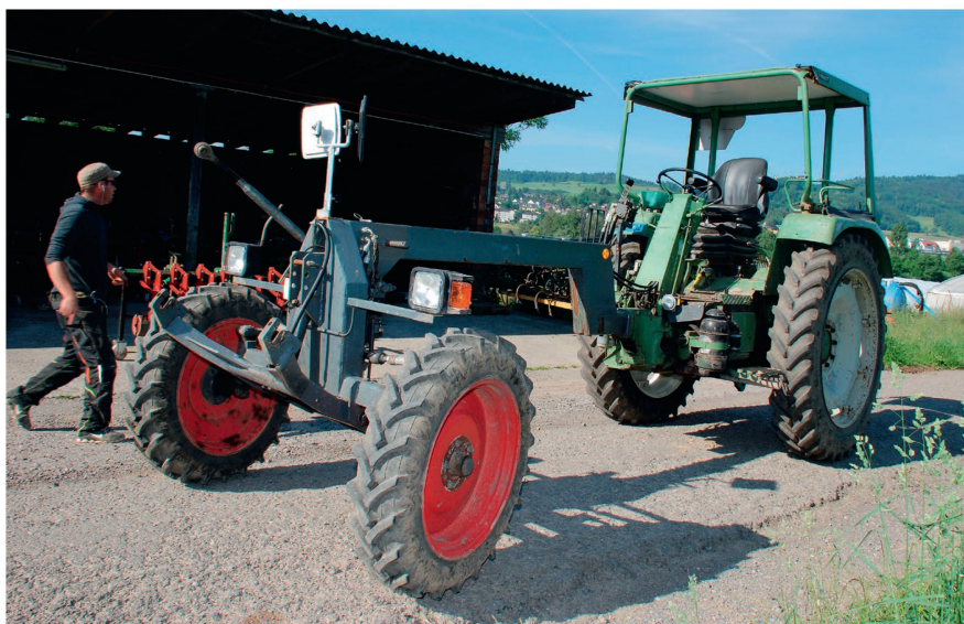
Fendt «GT 250» mit speziell hochgebautem Längsholm. Der Traktor ist einer von drei Fendt-Geräteträgern, die auf den Biobetrieben von Stephan und Martin Müller zum Einsatz kommen. Bilder: H. Röthlisberger
