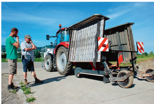
Neues leistungsstarkes 4,5-m-Abflammgerät von Hersteller Hoaf. «Mit diesem haben wir mehr Leistung und einen geringeren Gasverbrauch als mit dem bisherigen», sagt Martin Müller.
