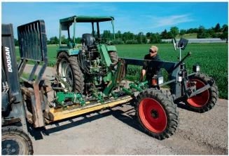
Dadurch, dass der Längsholm am Fendt-Geräteträger hoch angesetzt ist, können die verschiedensten Striegel und Hackgeräte unten angebaut werden.
