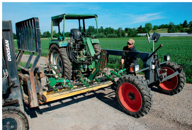
Dadurch, dass der Längsholm am Fendt-Geräteträger hoch angesetzt ist, können die verschiedensten Striegeln und Hackgeräte unten angebaut werden.
