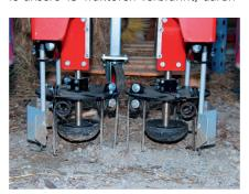
Mit diesen rotierenden Zinken-Tellern wird zwischen den Kulturen der Boden «aufgerissen» und das Unkraut entfernt.
