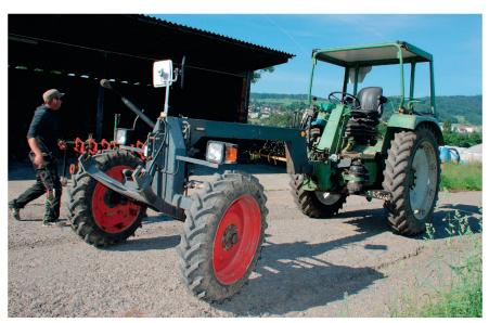
Fendt «GT 250» mit speziell hochgebautem Längsholm. Der Traktor ist einer von drei Fendt-Geräteträgern, die auf den Biobetrieben von Stephan und Martin Müller zum Einsatz kommen. Bilder: H. Röthlisberger
