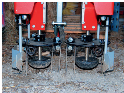
Mit diesen rotierenden Zinken-Tellern wird zwischen den Kulturen der Boden «aufgerissen» und das Unkraut entfernt.
