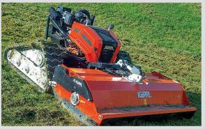
Hang exakt in einer Linie läuft. Sensoren messen die Raddrehzahl kontinuierlich und geben sie an die Steuerung weiter. Die Fahrgeschwindigkeit lässt sich per Tempomat an der Fernbedienung bis maximal 6 km/h einstellen und – zum Beispiel nach einem Wendemanöver – per Tastendruck wieder aufrufen
