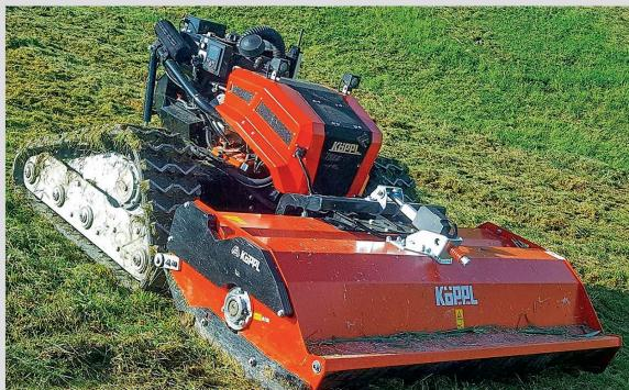
lauf sorgt dafür, dass die Maschine am Hang exakt in einer Linie läuft. Sensoren messen die Raddrehzahl kontinuierlich und geben sie an die Steuerung weiter. Die Fahrgeschwindigkeit lässt sich per Tempomat an der Fernbedienung bis maximal 6 km/h einstellen und – zum Beispiel nach einem Wendemanöver – per Tastendruck wieder aufrufen.
