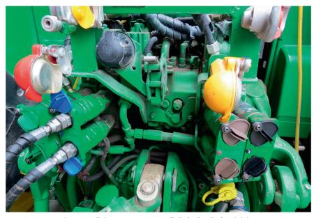
In Ergänzung zu einem Zweileiter-Bremssystem soll die hydraulische Einleiter-Bremse weiterhin erlaubt sein, damit der Betrieb bestehender Anhänger auch in Zukunft möglich ist. Bild: M. Abderhalden
