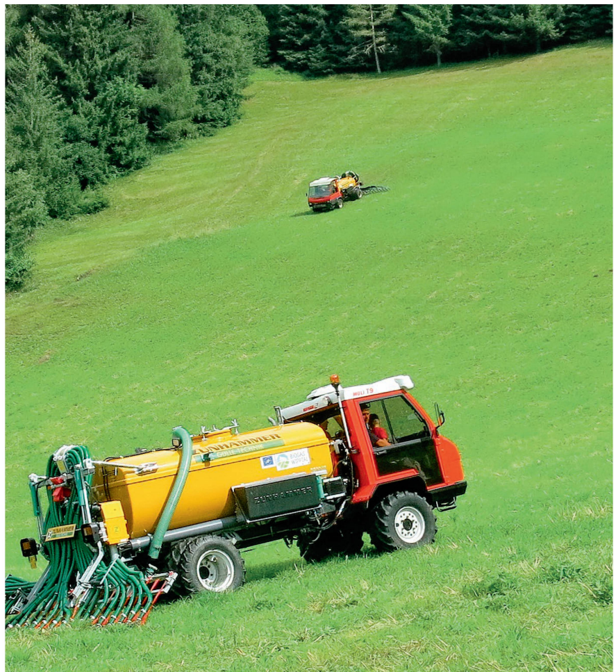
Die Gülleausbringung mit Schleppschuh oder Gleitfuss soll sich auch im Berggebiet eignen.
