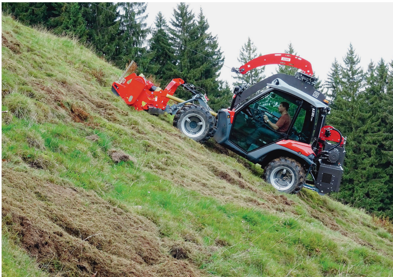
Tradition und Innovation kompakt in einer modernen Maschine verbaut: ein Aebi «TT 281» mit Überkopfwinde im Steilhang. Bild: R. Engeler
