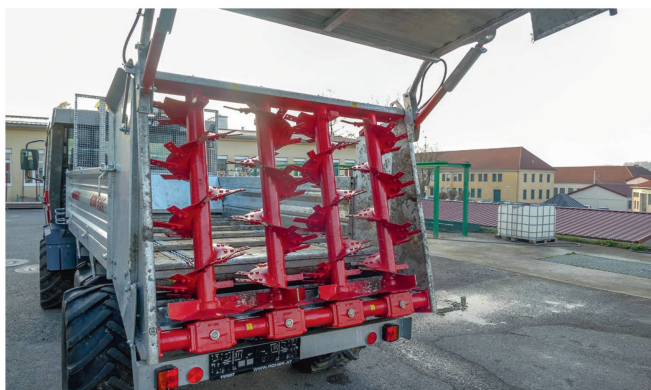
Der «ASM 235» hat vier stehende Streuwalzen mit geschraubten und wendbaren Fräsklingen.
