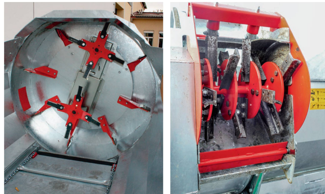
Das Gafner-Streuwerk erzielte bei unseren Streuversuchen die gleichmässigste Längsverteilung.
