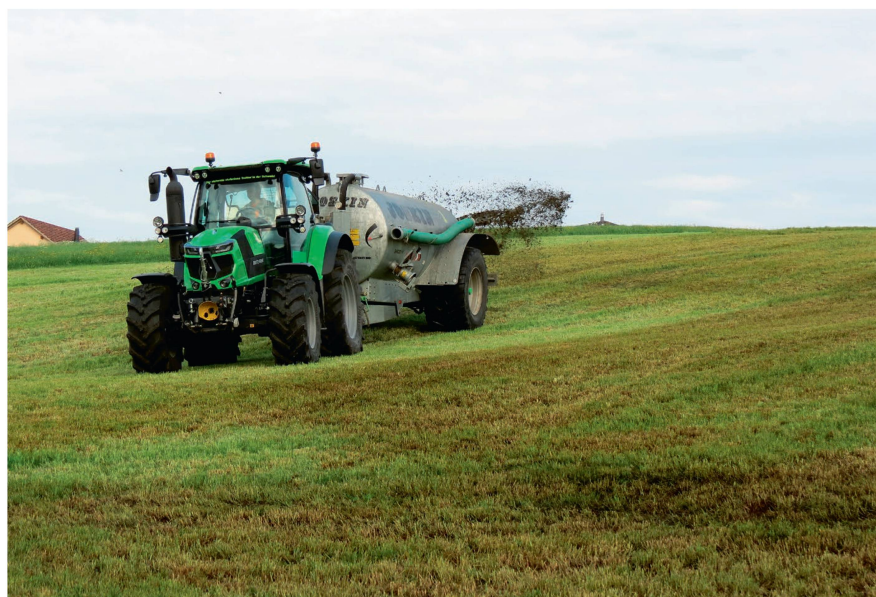
Die guten Vierradbremmen machen den Traktor auch am Hang zu einem sicheren Fahrzeug.
