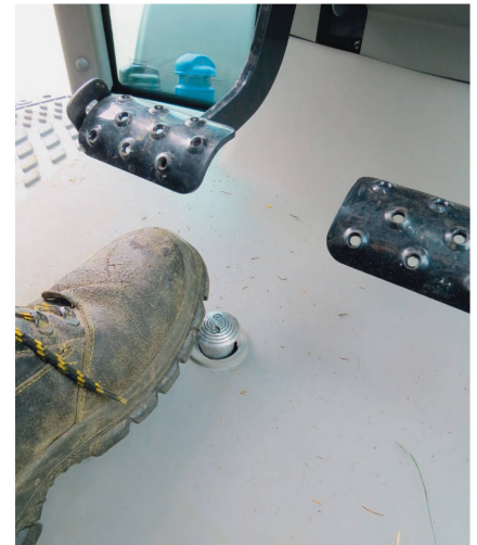
Per Fusstaster auf dem Kabinenboden wird die hydraulische Motorbremse zugeschaltet.
