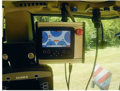
Das Triebachse wird über eine separate Bedienungseinheit gesteuert. Am Farbbildschirm lassen sich die Werte gut ablesen.
