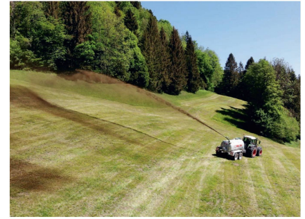
Die Weitwurfdüse erzielt eine Reichweite von bis zu 75 m. Damit lassen sich nicht befahrbare Flächen aus der Distanz güllen.
