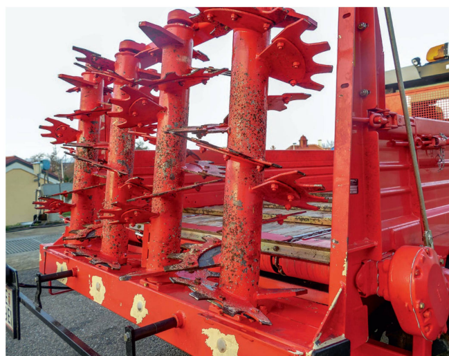
Ausgerüstet ist der «215» mit vier stehenden Streuwalzen mit geschraubten und wendbaren Fräsfächern.
