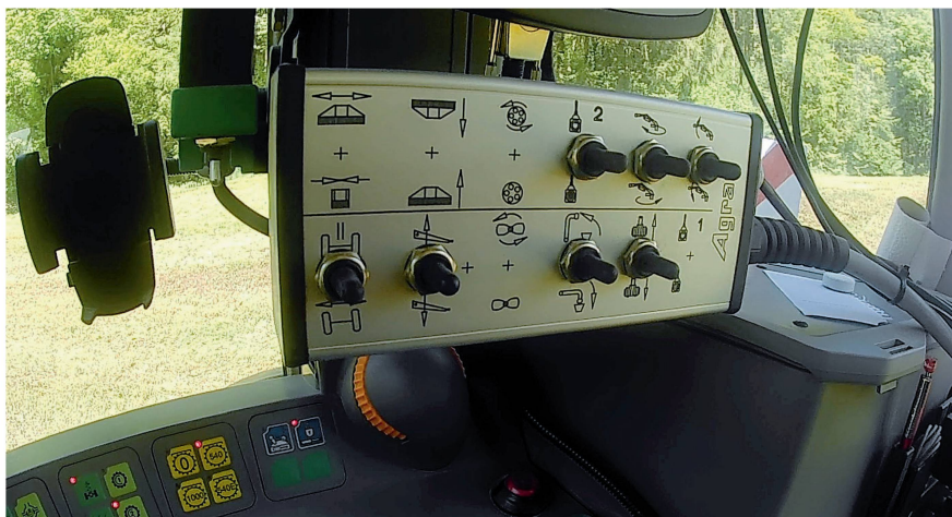
Bis zu zwölf Funktionen können über die elektrohydraulische Bedienung von der Kabine aus bequem betätigt werden.
