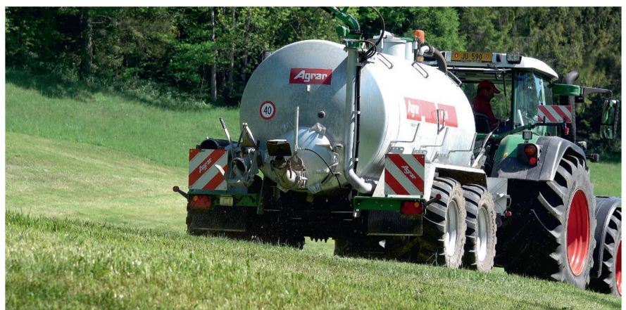
Dank Tandemachse und niedriger Bereifung wird ein tiefer, breit abgestützter Schwerpunkt erzielt.
