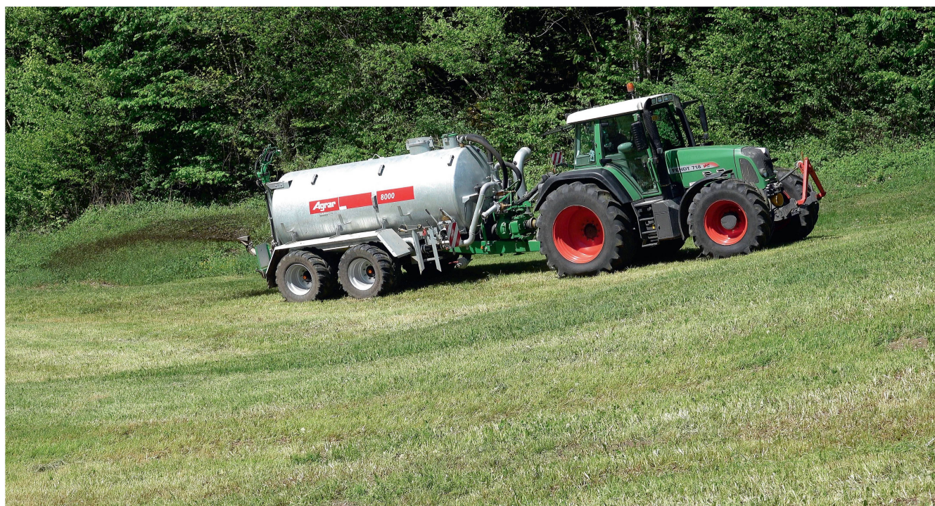
Dank Triebachssystem lassen sich auch mit gefülltem Güllefass beachtliche Steigungen ohne Landschafts- schaden überwinden. Bilder: R. Burkhalter
