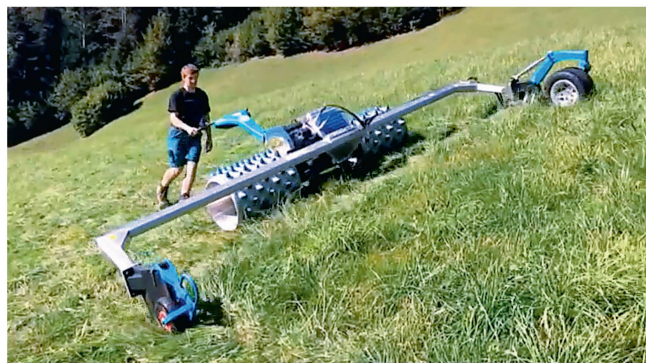
Bei grossen Arbeitsbreiten setzt Brielmaier zunehmend auf Räder, die den Futterfluss am Innenschuh verbessern und dank exzentrischer Aufhängung das Manövrieren rückwärts erleichtern.
