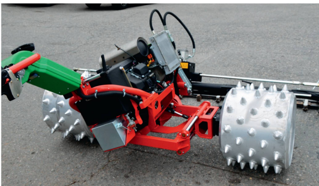
Der «Tecno» von Aebli ermöglicht als einziges Modell auf dem Markt eine zweidimensionale Schwerpunktverschiebung. Bild: R. Hunger
