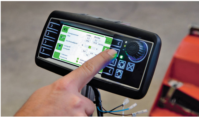
Mit einem Diagnosetool ermöglicht es Rapid, die Einstellungen der Elektronik zu personalisieren, und vereinfacht die Diagnose bei Pannen. Bild: Rapid
