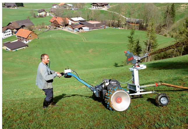
Zum Gülleverschlauchen wird ein elektrisch angetriebener Schwenkverteiler auf einem leichten Fahrwerk eingesetzt.
