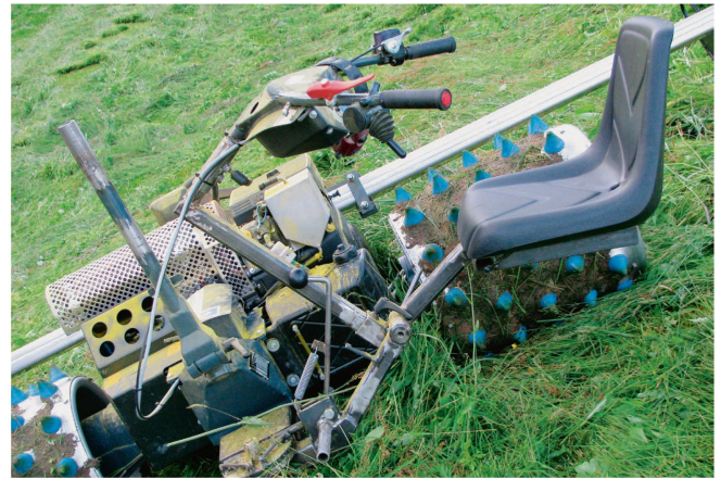
Beim ersten Prototyp der «Mitfahrgelegenheit» waren Fahrersitz und Bedienungseinheit zusammen am Schwenkmechanismus befestigt.
