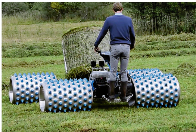
In Verbindung mit der Brielmaier-Stehplattform wird die Bedienung über einen Zweifach-Klappmechanismus nach vorne verschoben.
