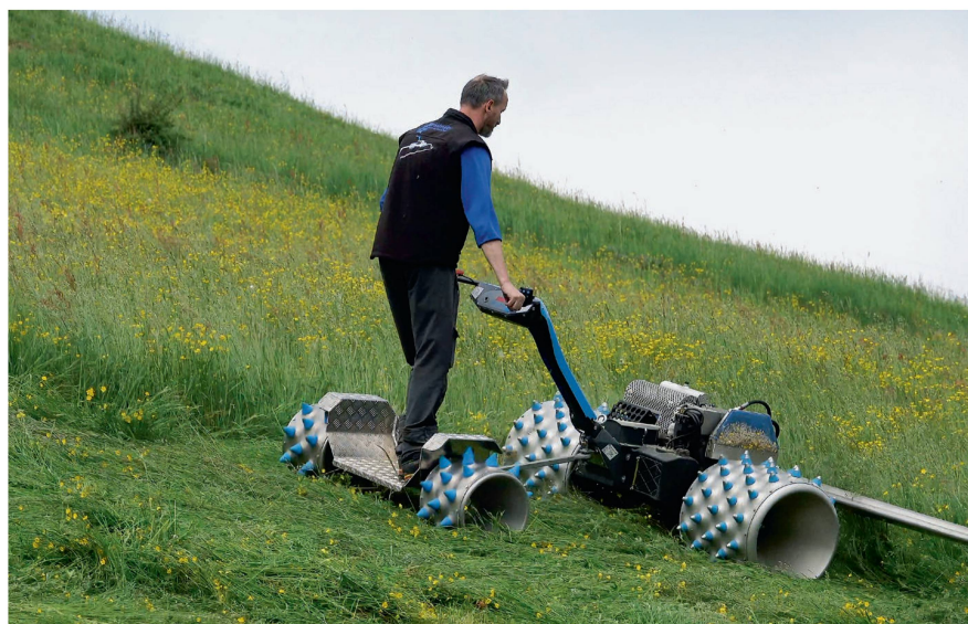
Mit dem «Formel 1 smaal Car» kann man entweder stehend oder mit dem optional erhältlichen, gefederten Schwenksitz arbeiten. Bild: R. Burkhalter
