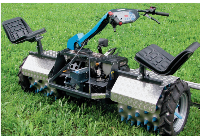
In der zweiten Version der «Mitfahrgelegenheit» wird mit zwei fix eingesteckten Fahrersitzen gearbeitet.
