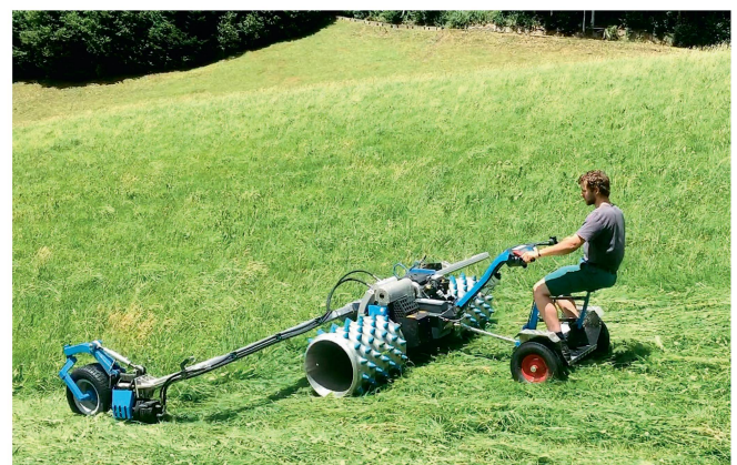
Der «Formel 1 smaal Car» mit Luftbereifung kann in Hanglagen bis 60% Neigung eingesetzt werden und ist deutlich günstiger als mit Stachelwalzen.
