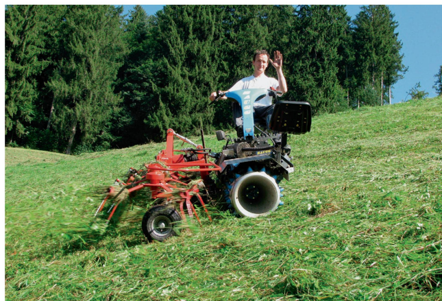
Der Kreiselheuer vom italienischen Hersteller Daros erreicht dank kurzer Anbaudistanz zum Fahrzeug eine gute Bodenadaptation.
