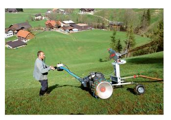
Zum Gülleverschlauchen wird ein elektrisch angetriebener Schwenkverteiler auf einem leichten Fahrwerk eingesetzt.
