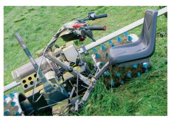
Beim ersten Prototyp der «Mitfahrgelegenheit» waren Fahrersitz und Bedienungseinheit zusammen am Schwenkmechanismus befestigt.
