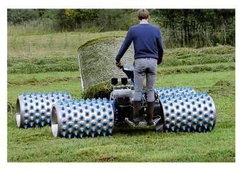
In Verbindung mit der Brielmaier-Stehplattform wird die Bedienung über einen Zweifach-Klappmechanismus nach vorne verschoben.
