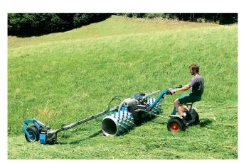
Der «Formel 1 smaal Car» mit Luftbereifung kann in Hanglagen bis 60% Neigung eingesetzt werden und ist deutlich günstiger als mit Stachelwalzen.
