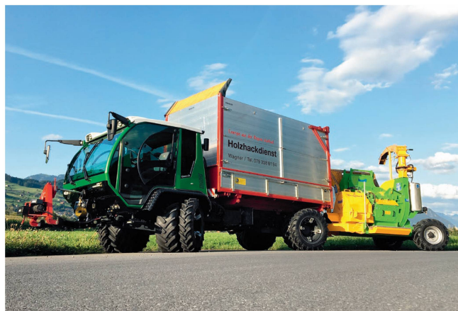
Mit 175 PS bieten die Transporter von Schiltrac genügend Leistung und Tragfähigkeit für Front/Heck-Kombinationen und gezogene Rundballenpressen oder Holzhacker. Bild: Schiltrac
