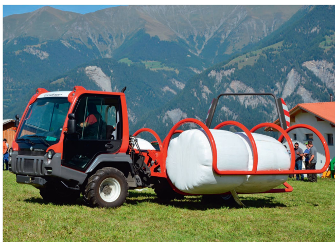
Mit dieser Einzelanfertigung von Gerg aus Deutschland lassen sich sechs Rundballen nach dem Selbstladerprinzip transportieren.
