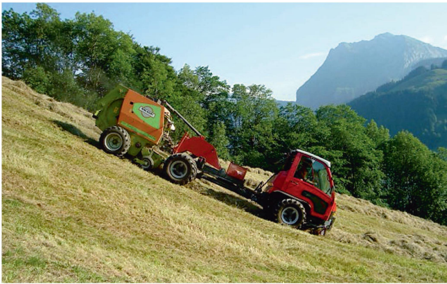
Durch die am Dreipunktbock angebaute Rundballenpresse wird der Schwerpunkt des Fahrzeugs kaum erhöht. Bild: Thomas Walder
