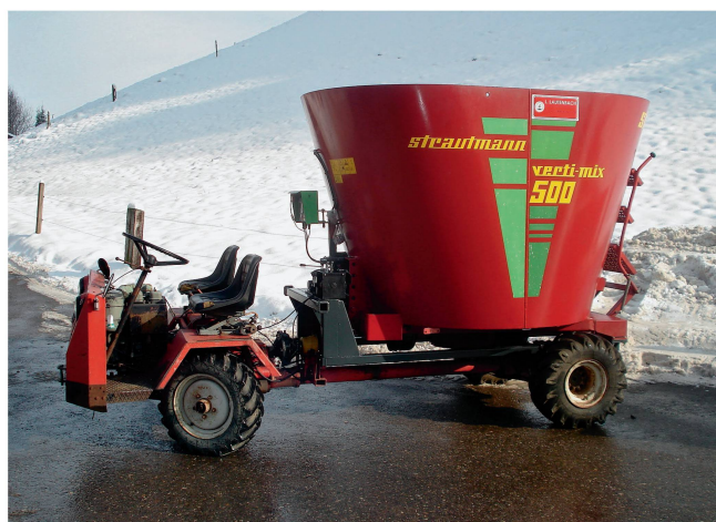
Der Transporter ist die geländegängigste Variante des selbstfahrenden Futtermischers und bringt eine sinnvolle Auslastung im Winter.
