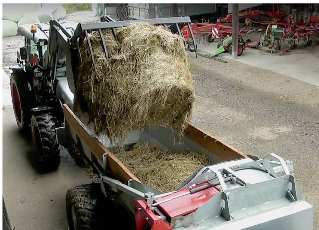
Mit der «Everyday»-Zusatzausrüstung lassen sich die Seitenstreuer von Gafner einfach zum Füttern und Einstreuen einsetzen. Bild: Gafner
