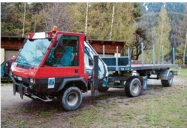
Mit einem Sattelanhängen lassen sich die Ladefläche und die Nutzlast deutlich vergrössern. Es bleibt genug Platz für einen Kranaufbau. Bild: Jordi
