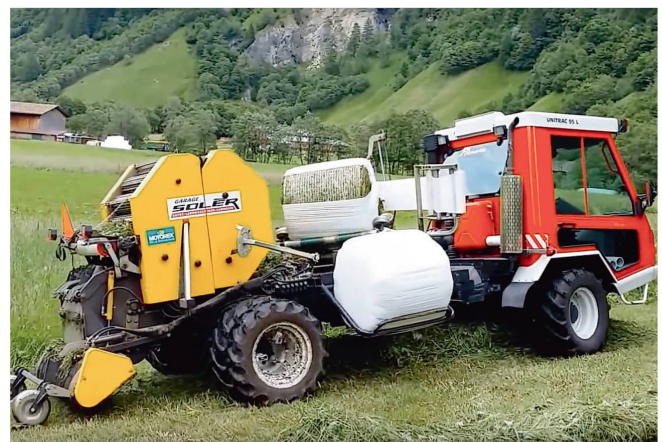
Mit der Presswickel-Kombination «Prewitra» von Bürger lassen sich drei Rundballen mit Ballenmass 80x90 cm transportieren. Bild: Bürger
