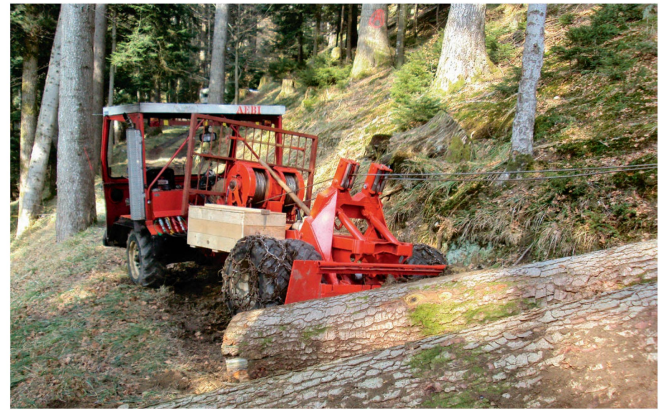
Der klassische Forstaufbau ist zwar teurer als die Version mit Dreipunktwinde, bietet aber eine bessere Gewichtsverteilung. Bild: Jordi
