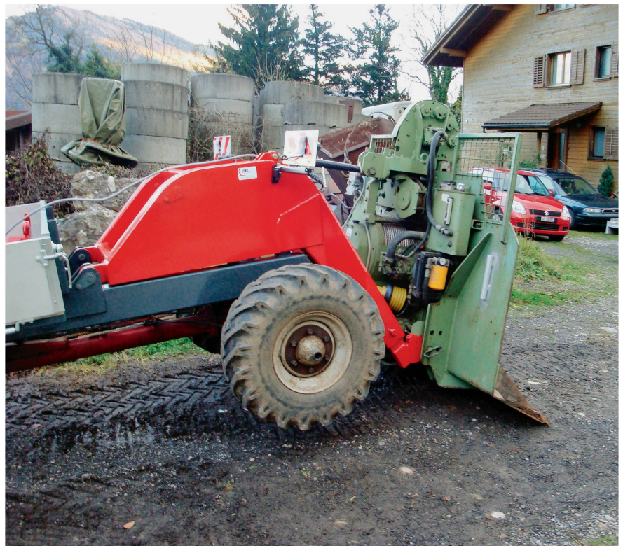
Durch den Dreipunktbock von Jordi lässt sich das Einsatzspektrum eines Transporters mit herkömmlichen Dreipunkt-Anbaugeräten stark vergrössern. Bild: Jordi
