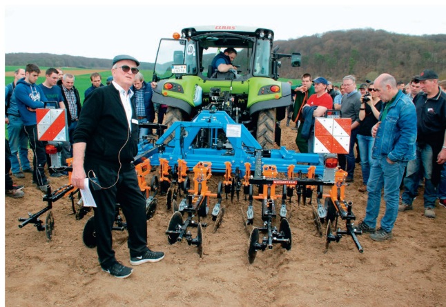
Schmotzer-Chef Ferdinand Wahl zeigt das neue Dampfpflegegerät. Mit Schneidscheiben wird der Damm zuerst seitlich leicht aufgeschnitten, bevor die nachfolgenden Scheiben den Damm wieder häufeln.
