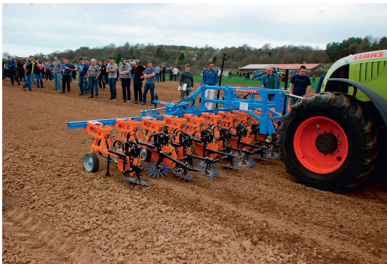
Mit der 6-Meter-Frontanbau-Blindhacke, die unter anderem mit Fingerrädern ausgestattet ist, wird direkt wenige Tage nach der Aussaat über das gesamte Feld inklusive der Reihe sehr flach gehackt. Bilder: Heinz Röthlisberger
