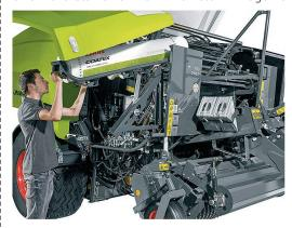
(1750 m Lauflänge) oder 17 Mikrometern (2000 m Lauflänge) gewählt werden. Bei der Mantelfolienbindung gibt es im Arbeitsverlauf bis auf das Bindematerial keine Unterschiede zur gängigen Netzbindung. Hat ein Ballen in der Presskammer die gewünschte Grösse erreicht, wird er automatisch mit bis zu acht Folienlagen «Coatex» gebunden. Anders als beim Netz ragen die Folienlagen einige Zentimeter über die seitli-
