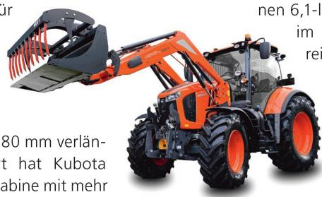
Komfort. Verbaut wird ein elektro-hydraulisches 36x36-Getriebe. Vorgestellt hat Kubota auch den «M6121» (Bild), der mit einer 110-l/min-Hydraulikpumpe gut für Frontladerarbeiten eingesetzt werden kann. Der «M6121» hat einen 6,1-l-Motor mit 115 PS im Nenndrehzahlbereich. Mit Boost gibt es 20 PS zusätzlich. Für den Antrieb sorgt ein 5-Gang-Getriebe mit 6 Lastschaltstufen.
