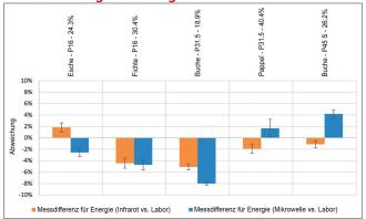
Fehler der Laboranlage bei der Messung des Energiegehalts von Hackschnitzeln verschiedener Holzarten, Hackschnitzelgrössen (P16, P31.5, P45 S) und Feuchtigkeiten (zwischen 18,9 und 40,4 %). Die gemessenen Abweichungen beziehen sich jeweils auf eine Vergleichsmessung, die unabhängig von der Testanlage durchgeführt wurde.
