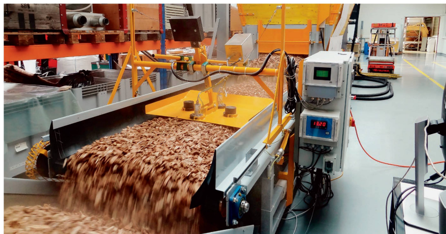
Die Forscher der Fachhochschule in Yverdon haben die Messung von Gewicht und Feuchtigkeit zuerst im Labor (Bild) getestet. Die gelbe Platte misst die Feuchtigkeit mit Mikrowellen, das silbriggraue Gerät (im Hintergrund) mit Infrarot. Bild: HEIG-VD
