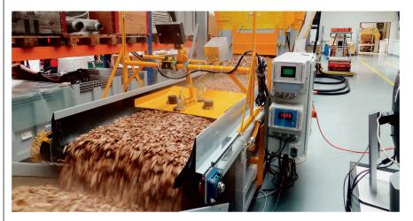
Die Forscher der Fachhochschule in Yverdon haben die Messung von Gewicht und Feuchtigkeit zuerst im Labor (Bild) getestet. Die gelbe Platte misst die Feuchtigkeit mit Mikrowellen, das silbriggraue Gerät (im Hintergrund) mit Infrarot. Bild: HEIG-VD
