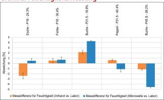
Messfehler der Laboranlage bei der Feuchtigkeitsmessung mit Infrarot (orange) und Mikrowellen (blau) für verschiedene Holzarten, Hackschnitzelgrössen (P16, P31.5, P45 S) und Feuchtigkeiten (zwischen 18,9 und 40,4%). Die Abweichungen beziehen sich jeweils auf eine Vergleichsmessung, die unabhängig von der Testanlage durchgeführt wurde: Die Feuchtigkeitsmessung gemäss Norm basiert auf einer Massenmessung im Rohzustand und einer weiteren Massenmessung nach absoluter Trocknung des Holzes bei 105°C.
