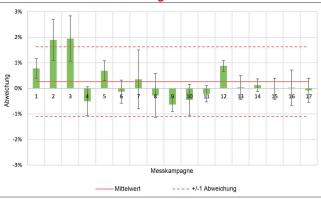
Die Grafik zeigt, mit welcher Genauigkeit die Laboranlage das Gewicht der Hackschnitzel bei 17 Messungen bestimmen konnte. Die ersten Messungen waren noch relativ ungenau, später aber nimmt der Messfehler dank verbesserter Kalibrierung immer mehr ab und liegt zuletzt deutlich unter 1% Abweichung. Die Abweichungen beziehen sich jeweils auf eine Vergleichsmessung, die unabhängig von der Testanlage durchgeführt wurde. Grafik: HEIG-VD
