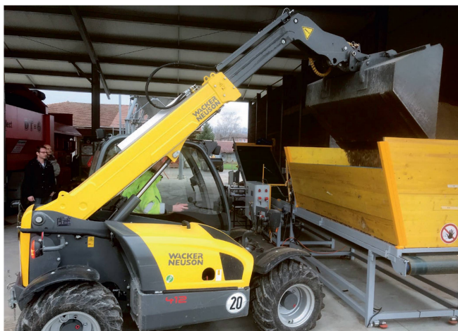
Messanlage im Feldversuch bei dem Hackschnitzel-Lieferanten Germaplaket in Yverdon: Ein Teleskoplader füllt Hackschnitzel in den Trichter, von wo sie auf das Förderband gelangen.
