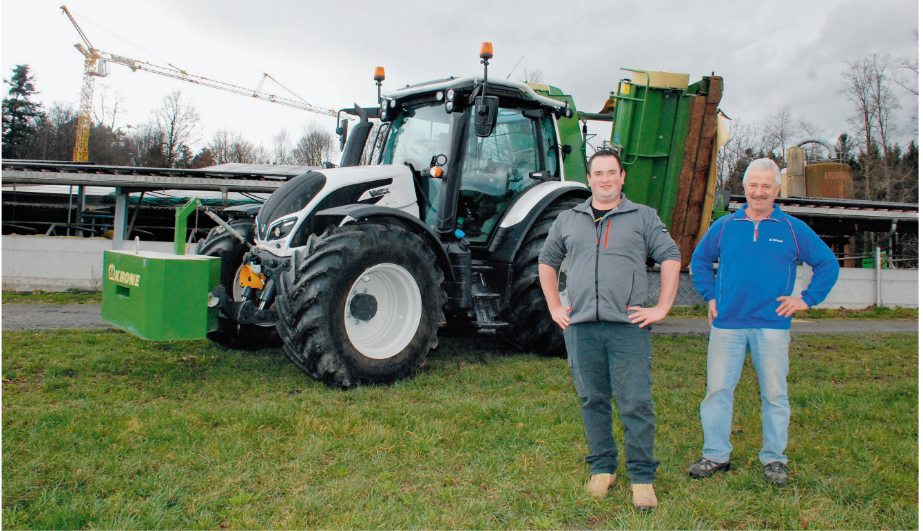
Jean-Jacques (59) Duperrex und sein Sohn Serge (26) mit der Traktor-Mäh-Kombination, die sie seit letzter Saison auf ihrem Betrieb in Knonau einsetzen. Für den Strassentransport wird das Heckmähwerk in der Mitte aufgeklappt. Bilder: röt/zvg
