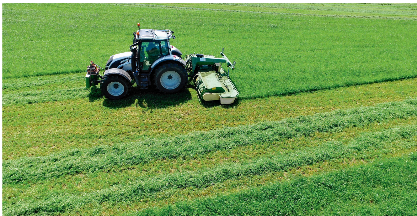
Dank der Schwadzusammenführung kann der Schwad auch in der Mitte abgelegt werden. Damit lassen sich nachfolgende Arbeitsschritte mit dem Kreisler oder dem Schwader einsparen.
