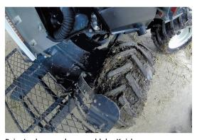
Beim Lenken werden sowohl das Knickgelenk als auch die Achsschenkellenkung betätigt.
