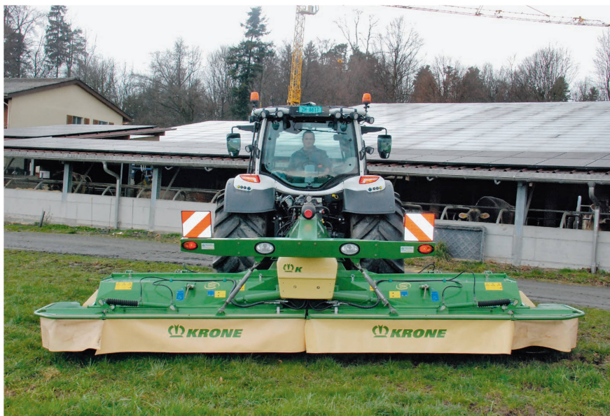
Die Duperrex mähen rückwärts mit Rückfahreinrichtung und einem speziellen 5,40-m-Mähwerk, das sonst nur am Krone-«Big-M»-Selbstfahrer zum Einsatz kommt.
