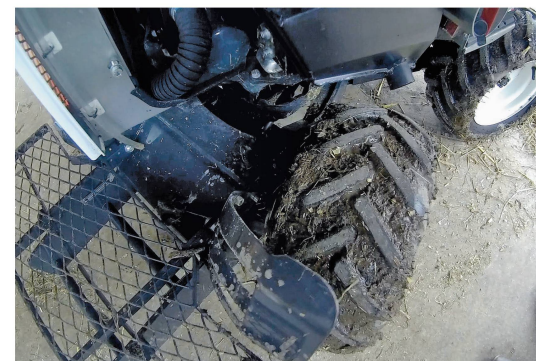
Beim Lenken werden sowohl das Knickgelenk als auch die Achsschenkelenkung betätigt.
