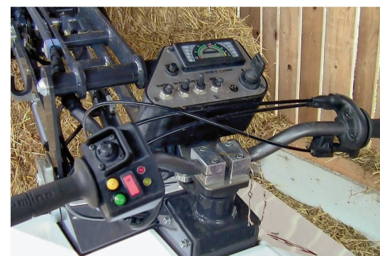
Alle Bedienelemente und Anzeigen sind auf der Lenkstange montiert, die Anzeigen mit Stundenzähler sogar nachts beleuchtet.
