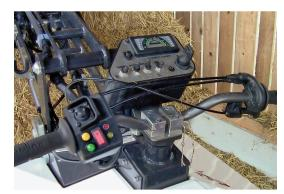
Alle Bedienungselemente und Anzeigen sind auf der Lenkstange montiert, die Anzeigen mit Stundenzähler sogar nachts beleuchtet.
