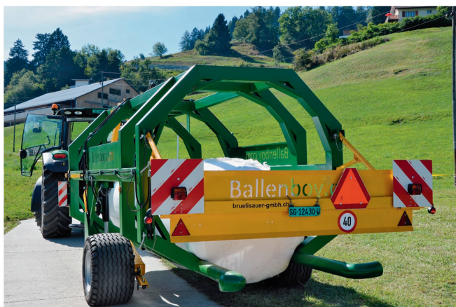
Dank Schwenkdeichsel kann beim Beladen und Entladen des «Ballenboy» immer vorwärts gefahren werden. Bilder: R. Hunger
