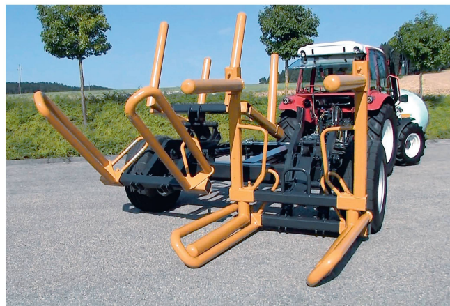
Auf dem sehr kurzen «Silo Trans» von Mammut werden die Ballen in vier einzelnen Gabeln festgehalten. Bilder: Mammut
