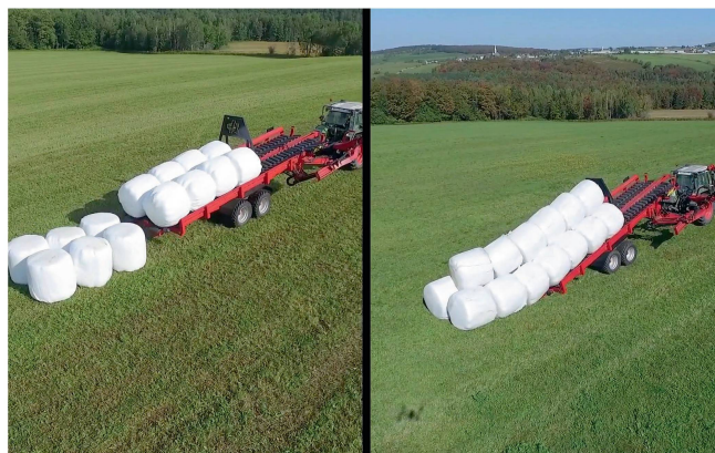
Der «RBM 2000» von Anderson kann mit 14 oder 20 Siloballen beladen werden. Entladen wird stehend oder liegend. Bilder: Anderson Group
