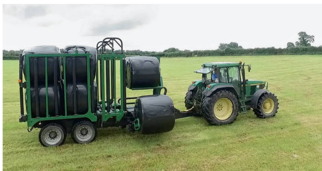
Diese Eigenentwicklung eines irischen Milchbauern arbeitet mit einem Rollenkäfig, der zum Entladen nach hinten kippt. Bilder: agriland.ie
