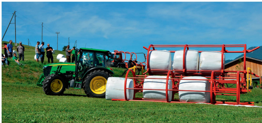
Der «Bale Transporter» von Keltec arbeitet mit zwei schwenkbaren Hebebeinen, die in Transportstellung ineinandergreifen. Bilder: R. Hunger
