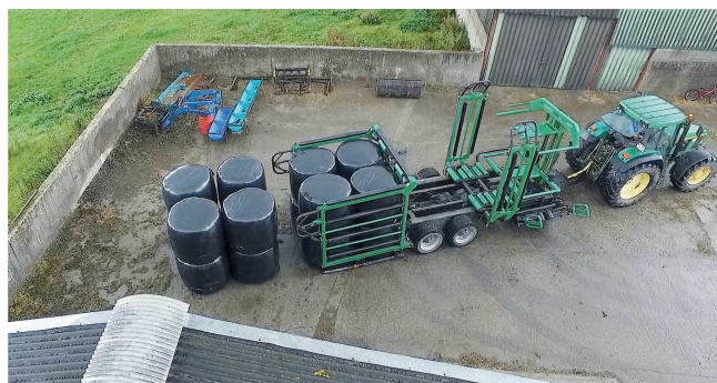
Diese Eigenentwicklung eines irischen Milchbauern arbeitet mit einem Rollenkäfig, der zum Entladen nach hinten kippt. Bilder: agriland.ie
