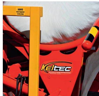
Der «Bale Transporter» von Keltec arbeitet mit zwei schwenkbaren Hebebeinen, die in Transportstellung ineinandergreifen. Bilder: R. Hunger
