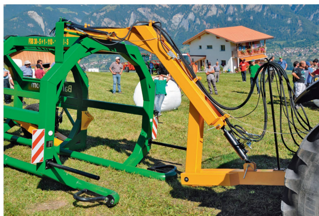
Dank Schwenkdeichsel kann beim Beladen und Entladen des «Ballenboy» immer vorwärts gefahren werden. Bilder: R. Hunger
