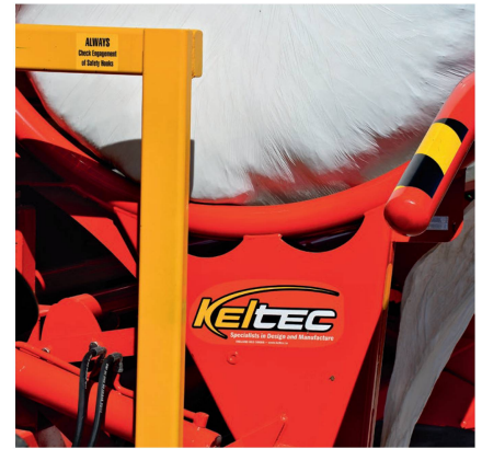
Der «Bale Transporter» von Keltec arbeitet mit zwei schwenkbaren Hebezangen, die in Transportstellung ineinandergreifen. Bilder: R. Hunger
