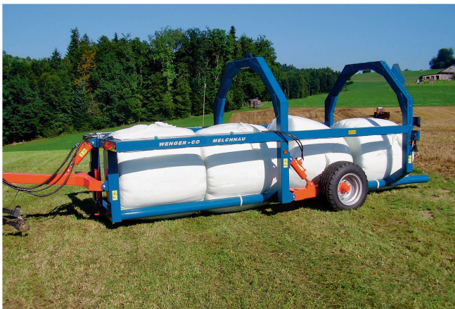
Der Rundballentransportwagen von Wenger benötigt wenige bewegliche Teile und nimmt die Ballen hinten auf. Bilder: Wenger
