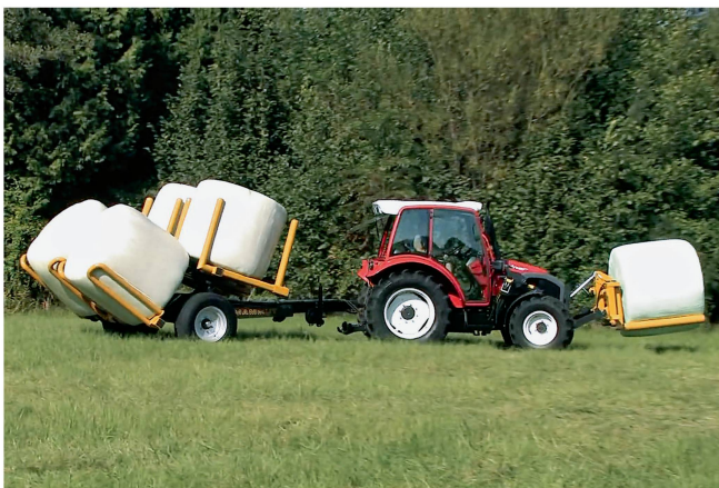
Auf dem sehr kurzen «Silo Trans» von Mammut werden die Ballen in vier einzelnen Gabeln festgehalten. Bilder: Mammut
