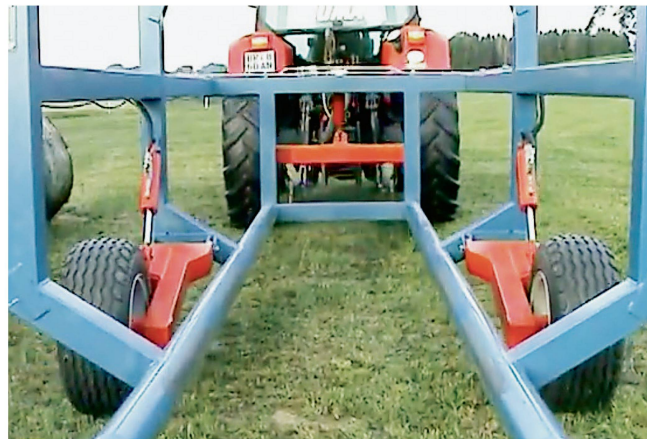
Der Rundballentransportwagen von Wenger benötigt wenige bewegliche Teile und nimmt die Ballen hinten auf. Bilder: Wenger
