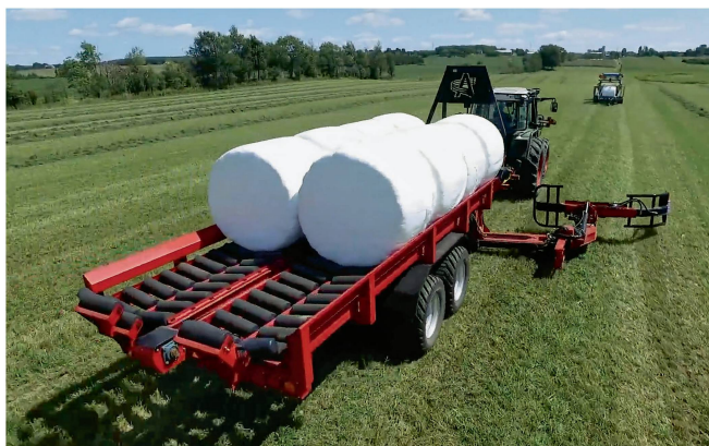
Der «RBM 2000» von Anderson kann mit 14 oder 20 Siloballen beladen werden. Entladen wird stehend oder liegend. Bilder: Anderson Group
