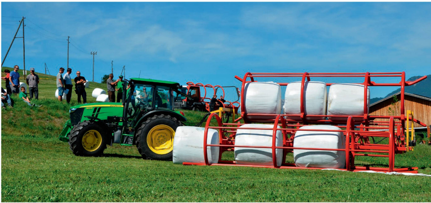
Der «Bale Transporter» von Keltec arbeitet mit zwei schwenkbaren Hebezangen, die in Transportstellung ineinandergreifen. Bilder: R. Hunger
