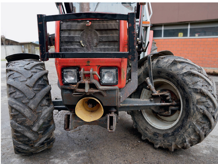
Der Radeinschlag von 52 Grad am «1750er» ist enorm.
