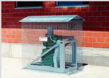
Bei festmontierten Güllerührwerken verhindert ein festes Schutzgitter, dass bewegliche Teile berührt werden können. Nach Serviceund Reparaturarbeiten ist die Schutzvorrichtung unverzüglich wieder zu montieren. Durch die funktionsbedingte, kleine Öffnung können während des Aufrührens der Gülle Gase austreten.
