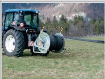
Im Einmann-Betrieb ist der hydraulisch betriebene Schlauchhaspel stets aus der Kabine zu bedienen. Die Schlauchführung durch eine Drittperson ist gefährlich, da sie vom auflaufenden Schlauch erfasst werden kann.
