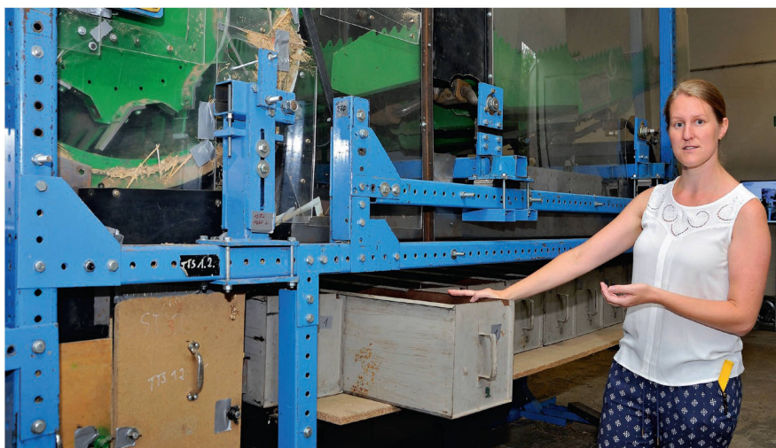
Mit Hilfe der Auffangkästen unter dem Mähdrescherversuchsstand kann Anja Eggerl überprüfen, an welcher Stelle der Prozesskette Kornverluste auftreten.
