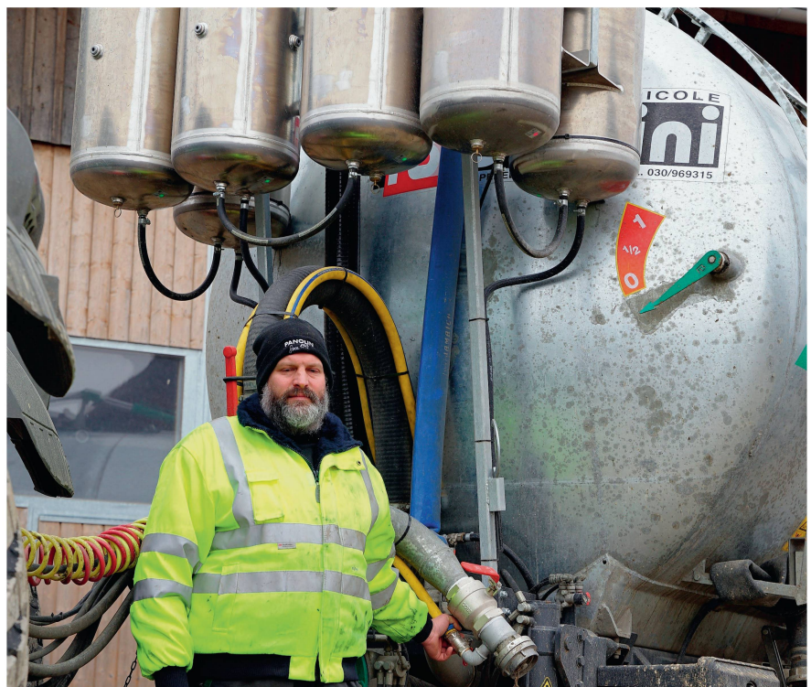
René Messer unter seiner selbst montierten Eigenentwicklung, dank der ein Schlauch mit dem Kompressor eines Traktors ausgeblasen werden kann. Bild: Dominik Senn
