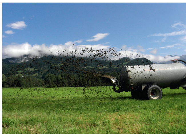
Möscha-Pendelverteiler: Arbeitsbreite bis 15 m; Pendelverteiler mit einem Verteilkopf. Angetrieben wird der Verteiler über den Güllestrahl.
