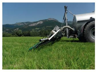
Fliegl-Schleppschuhverteiler: Arbeitsbreite 9 m; Schlauchabstand: 25 cm; Gewicht: 1030 kg.
