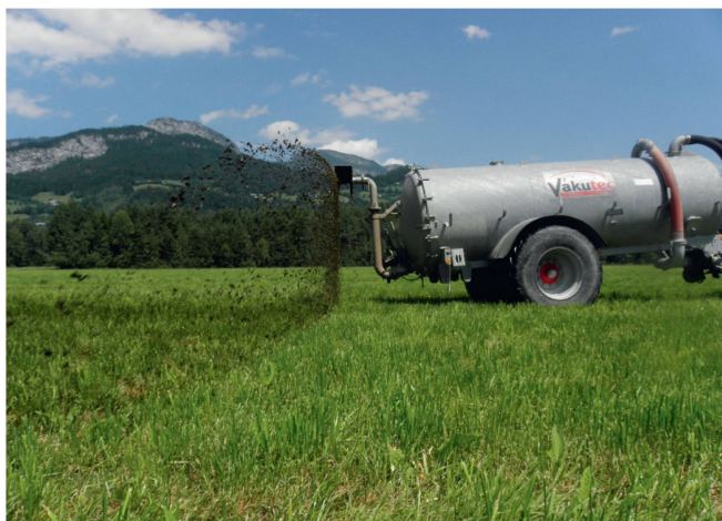
Vakutec-Prallkopfverteiler mit einer Arbeitsbreite von 12 m. Die Durchflussleistung lässt sich durch den Wechsel der Düse verändern.
