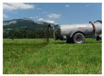
Vakutec-Prallkopfverteiler mit einer Arbeitsbreite von 12 m. Die Durchflussleistung lässt sich durch den Wechsel der Düse verändern.
