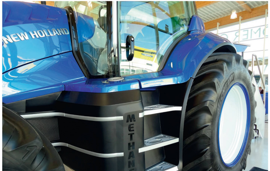
Die Tanks in mehrschichtiger Röhrenstruktur aus Verbundwerkstoff befinden sich in Einheiten an der Front und seitlich unterhalb der Kabine.
