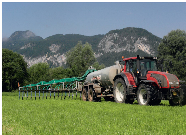
Kotte-Schleppschlauchverteiler (Baujahr 2011, nicht mehr erhältlich): Arbeitsbreite: 12 m; Schlauchabstand: 30 cm; Gewicht: 800 kg.
