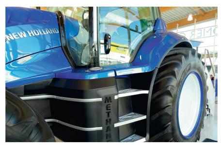
Die Tanks in mehrschichtiger Röhrenstruktur aus Verbundwerkstoff befinden sich in Einheiten an der Front und seitlich unterhalb der Kabine.
