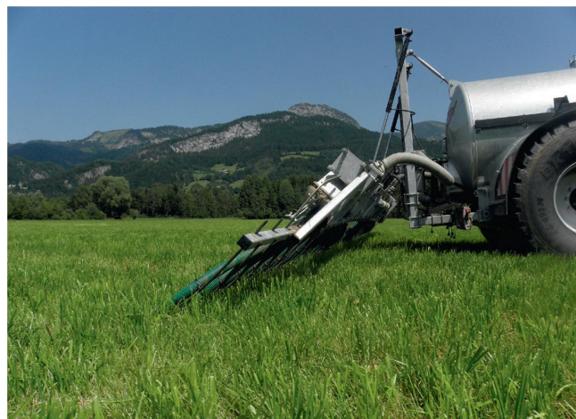
Fliegl-Schleppschuhverteiler: Arbeitsbreite 9 m; Schlauchabstand: 25 cm; Gewicht: 1030 kg.
