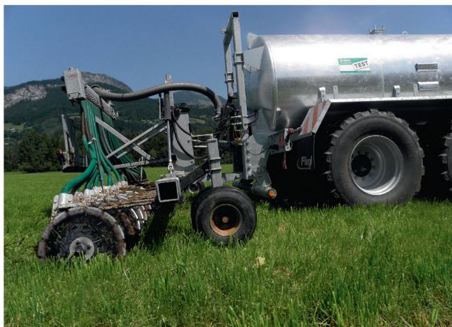
Das Scheibenschlitzgerät von Fliegl: Arbeitsbreite: 6,3 m; Gewicht: 1400 kg.
