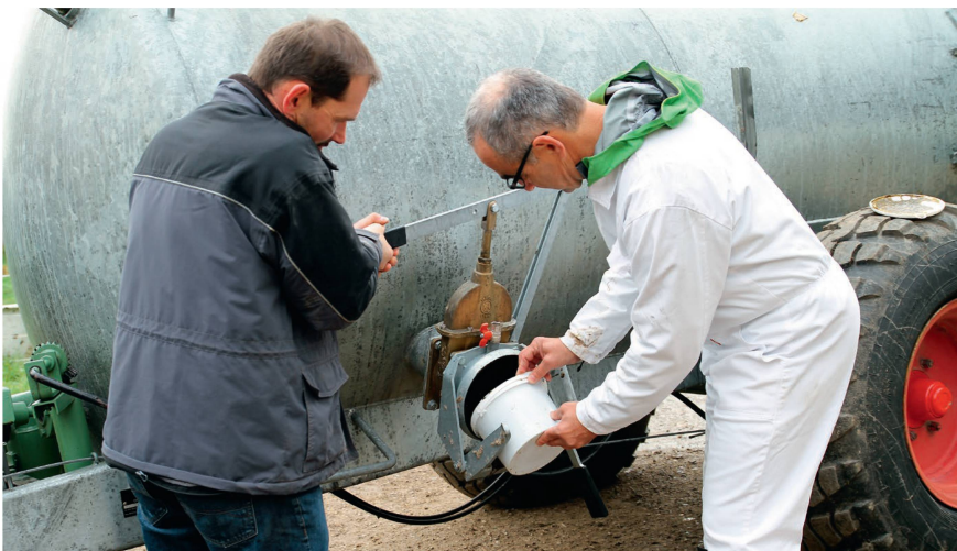
Bei jedem Versuchsdurchgang wurde eine Gülleprobe gezogen und auf die wichtigsten Inhaltsstoffe hin untersucht.
