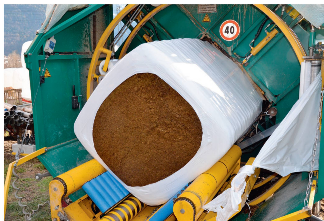
Die Lagerung von Güllefeststoffen in Silageballen ist eine saubere, jedoch aufwendige und teure Lösung. Bild: R. Hunger
