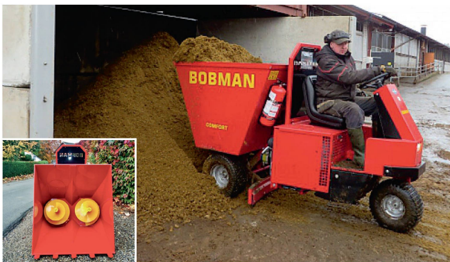
Für das Mischen mit Kalk und Verteilen von Feststoffen bieten sich neben Einstreuschaufeln auch kleine Selbstfahrer wie der «Bobman» mit Selbstladefunktion. Bild: Jydeland
