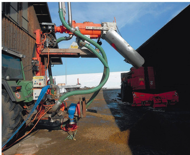
Dieser mobile Separator wurde für einfachen Transport und eine grössere Einsatzflexibilität (Überflurbehälter) auf einem Staplermast montiert. Bild: Kohli Gülletechnik
