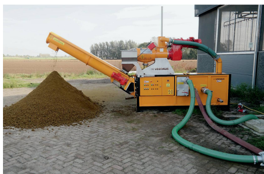
Bei «Plug&Play»-Lösungen, hier von Veenhuis, sind alle Komponenten sauber auf einer Rahmeneinheit montiert und lassen sich für den überbetrieblichen Einsatz einfach verladen. Bild: Veenhuis
