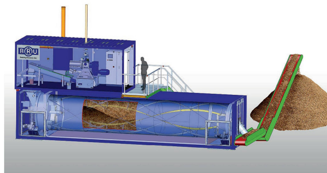
In Hygienisierungsanlagen wie der «Bedding Recovery Unit» (BRU) werden die Feststoffe durch Eigenerwärmung in einer Trommel getrocknet und hygienisiert. Bild: Bauer
