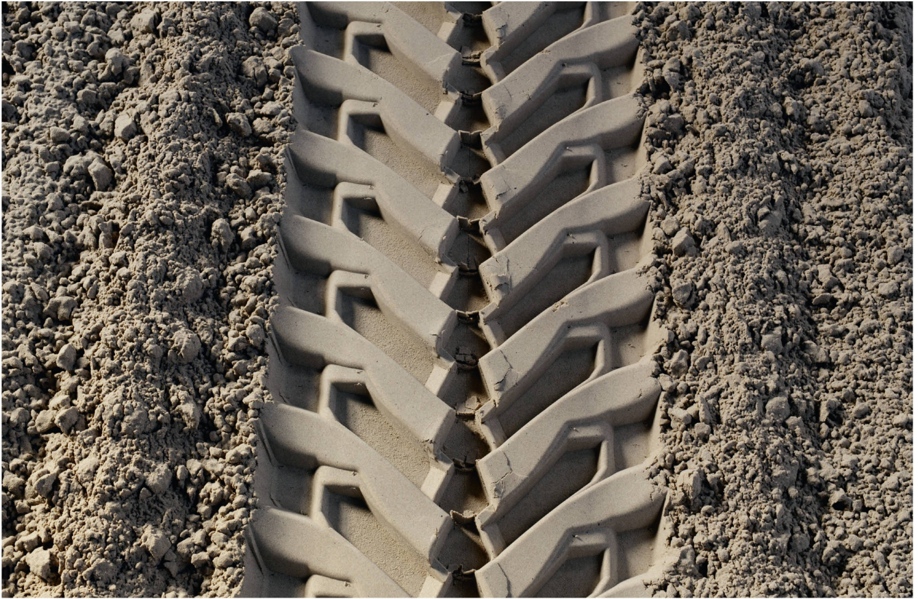
Der Reifendruck entscheidet, wie breit der Abdruck beim «EvoBib» von Michelin ist. Bilder: zvg
