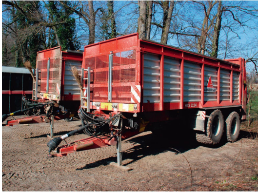
Jährlich schlägt der Betrieb «Château du Crest» mit diesen zwei 27-Kubik-Streuern zwischen 25 000 und 30 000 Tonnen Mist und Kompost um.
