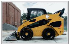
Tweel – die Michelin-Radkonstruktion ohne Luft besitzt eine Lauffläche aus Gummi, die auf einem Stahlgürtel sitzt und von radial nachgiebigen Speichen aus Polyurethan getragen wird. Diese geben auf unebenem Untergrund nach.
