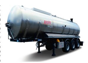
von Börger oder Vogelsang, wird das Fahrzeug laut dem Hersteller zügig befüllt. Weiter gibt es eine automatische und frei einstellbare Befüllendabschaltung. Die Gülleentnahme erfolgt wahlweise über einen schwenkbaren Saugarm (6") oder einen obenliegenden Absaugtrichter (8").
