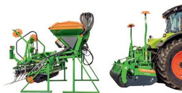
Genau wie bei den Aufbausämaschinen «Cataya» und «Centaya» ist die «AD-P 01 Special» laut dem Hersteller über die «QuickLink»-Schnittstelle mit dem jeweiligen Bodenbearbeitungsgerät verbunden. Mithilfe von «QuickLink» lässt sich das Bodenbearbeitungsgerät komfortabel von der Aufbausämaschine trennen.
