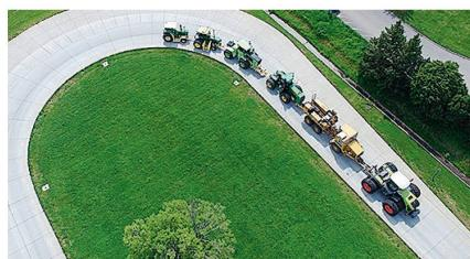
Ballastbedingungen durchgeführten Teil des Tests konnte der «Xerion 4500» den seit 25 Jahren bestehenden Rekord für das Zugkraft-Eigengewichtsverhältnis bei Traktoren mit Allradantrieb verbessern.
