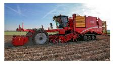
rechten äusseren Reihe sorgt. Weiter wurden Verbesserungen bei der Rodetechnik, bei den Aufhängungen und Umlenkungen der Siebbänder sowie bei der Zupfwalze vorgenommen. Für den Einsatz auf schweren Böden können jetzt verschleissfeste Scharplatten aus Kunststoff eingesetzt werden, die geringere Erdanhaftungen aufweisen.
