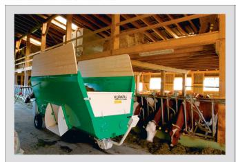
Im Freifall darf der Mischwagen nur von gesicherten Bühnen ober Abwurfluken aus befüllt werden. Zudem darf er nicht in Betrieb sein.
