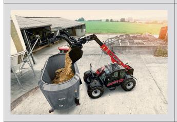
Fremdbefüller müssen stets indirekt mit Hebefahrzeugen, Förderband oder Kran befüllt werden.
