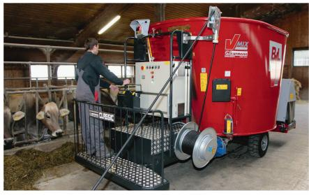
Stromgetriebene Mischwagen sind heute genauso leistungsfähig wie Mischwagen an Traktoren. Bilder: Kurmann, Schluechthof
