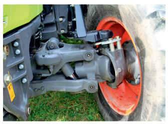
Die Vorderachse von Carraro mit Einzelradaufhängung ermöglicht einen Federweg von 90 mm.
