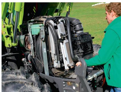
Der Motor benötigt nur alle 600 Stunden frisches Öl.
