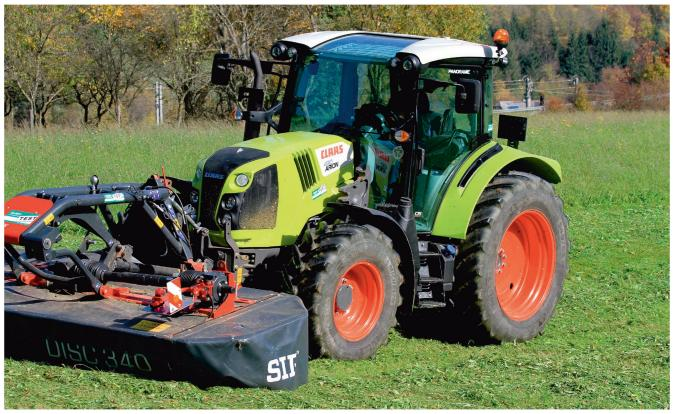
Statt des 4-Zylinder-Triebwerks von John Deere beim Vorgänger dieselt beim «Arion 430» nun ein gleich grosser Motor von Hersteller Fiat Powertrain (FPT) unter der Haube. Bilder: Johannes Paar
