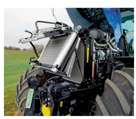
Eingebaut im «7-230» ist ein 205-PS-6-Zylinder-Turbo-Motor von FPT.
