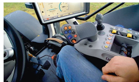
Geschaltet werden die Gruppen und Stufen am Multifunktionshebel an der Armlehne.
