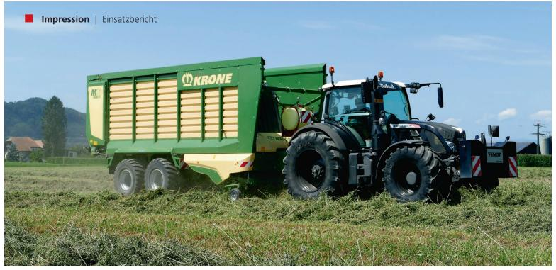
Der neue «MX 370 GD» von Oskar Schenk mit schwenkbarer Frontwand und selbst aufgebauter Siliermittel-Dosieranlage. Bilder: zvg
