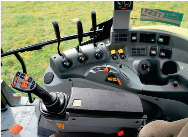
Alle Bedienelemente der rechten Konsole und der Multifunktionsgriff an der Armlehne sind gut erreichbar.
