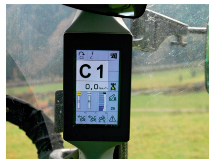
Der Fahrer kann alle Funktionen über das Armaturenbrett und das farbige Display im Kabinenpfosten steuern.
