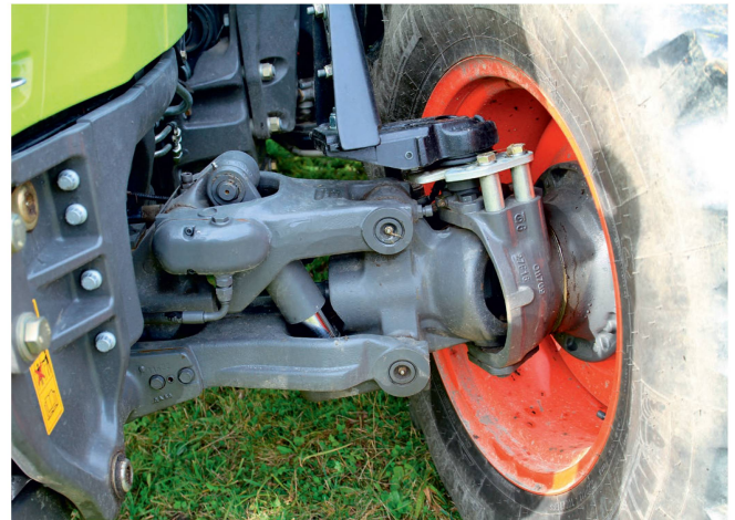
Die Vorderachse von Carraro mit Einzerradaufhängung ermöglicht einen Federweg von 90 mm.
