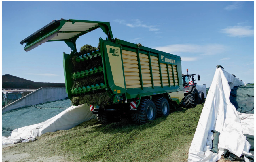
Die drei Walzen mit 470 mm Durchmesser sorgen für das zügige Abladen des Wagens.
