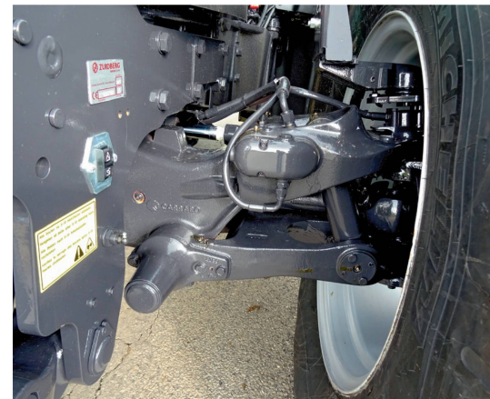
Die Einzelrad-Vorderachsfederung wird beim «Dynamic» elektronisch gesteuert.
