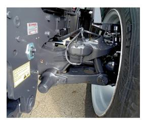
Die Einzelrad-Vorderachsfederung wird beim «Dynamic» elektronisch gesteuert.
