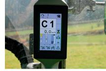
Der Fahrer kann alle Funktionen über das Armaturenbrett und das farbige Display im Kabinenpfosten steuern.
