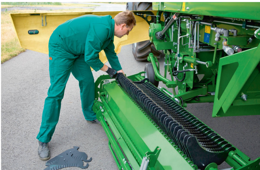
Die Messerkassette, die mit 41 Messern bestückt werden kann, wird für das Wechseln der Messer seitlich ausgeklappt.
