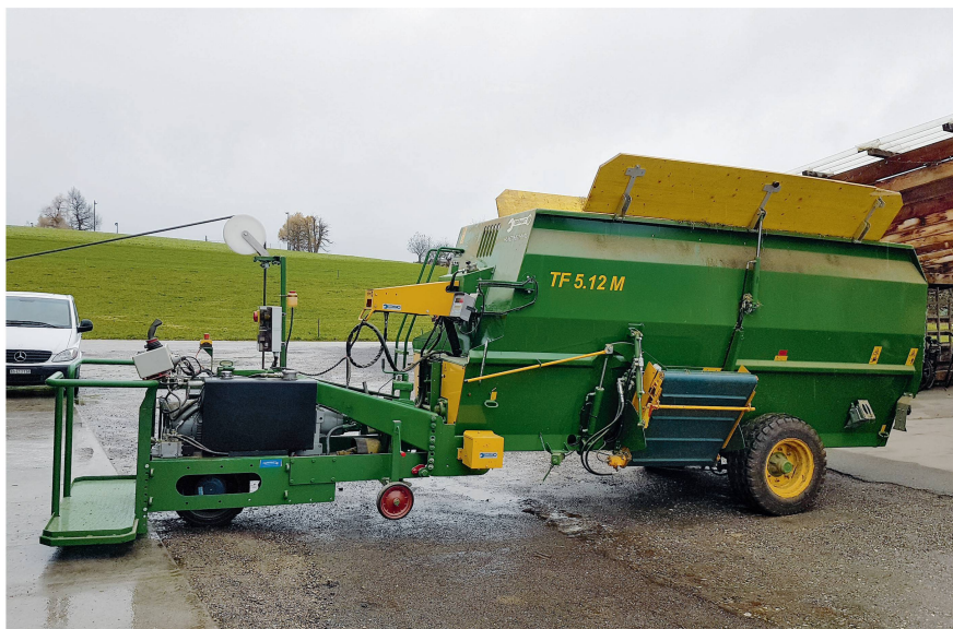
Dieser Fahrkopf von Odermann lässt sich bei Bedarf in kurzer Zeit von der Original-Anhänge-deichsel des Storti-Mischwagens trennen.
