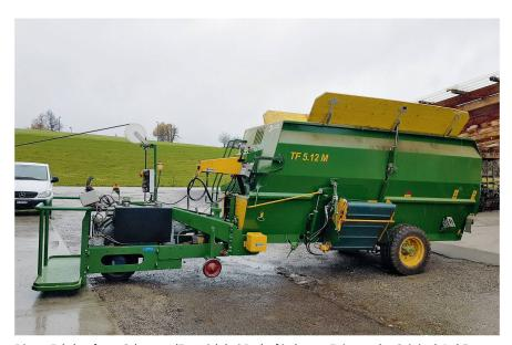
Dieser Fahrkopf von Odermatt lässt sich bei Bedarf in kurzer Zeit von der Original-Anhängedeichsel des Storti-Mischwagens trennen.
