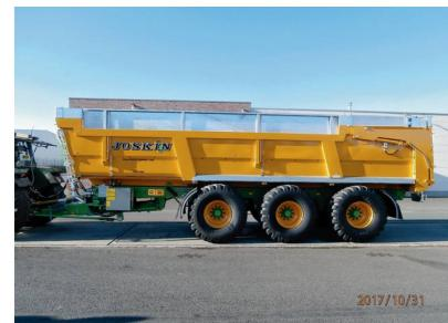
Seite und festen Bordwandaufsätze (optional) von 25 cm auf den anderen Seiten hat der Kasten eine Höhe von 1,75 m und ein Volumen von 36,2 m<sup>3</sup>. In der Standardversion ist die Höhe der hydraulischen Bordwanderhöhung auf 25 cm begrenzt für eine gesamte Kastenhöhe von 1,50 m.
