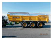
Seite und festen Bordwandaufsätzen (optional) von 25 cm auf den anderen Seiten hat der Kasten eine Höhe von 1,75 m und ein Volumen von 36,2 m³. In der Standardversion ist die Höhe der hydraulischen Bordwanderhöhung auf 25 cm begrenzt für eine gesamte Kastenhöhe von 1,50 m.
