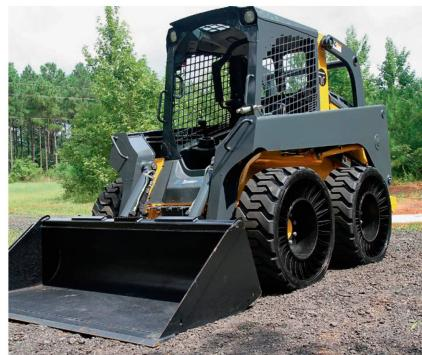
Michelin bringt eine luftlose Rad-Reifen-Kombination auf den europäischen Markt. Seit Anfang Jahr gibt es diese pannensichere Rad-Reifen-Kombination für Kompaaktlader, sogenannte Skid Steer Loaders, in zwei Ausführungen. Sie ersetzt Reifen, Felge und Ventil durch eine fest verbundene Rad-Reifen-Einheit. Da sie völlig ohne Luftdruck auskommt, ist sie pannensicherer als konventionelle Reifen und bietet dadurch ein besonders hohes Mass an Mobilität und Zuverlässigkeit.
