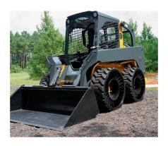
Michelin bringt eine luftlose Rad-Reifen-Kombination auf den europäischen Markt. Seit Anfang Jahr gibt es diese pannensichere Rad-Reifen-Kombination für Kompaktlader, sogenannte Skid Steer Loaders, in zwei Ausführungen. Sie ersetzt Reifen, Felge und Ventil durch eine fest verbundene Rad-Reifen-Einheit. Da sie völlig ohne Luftdruck auskommt, ist sie pannensicherer als konventionelle Reifen und bietet dadurch ein besonders hohes Mass an Mobilität und Zuverlässigkeit.
